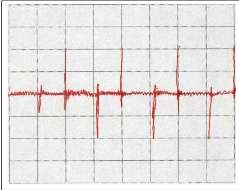
Figura 2.25 Señal de forjado proveniente del acelerómetro con 1V/div y 50us/div
