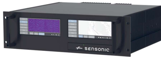
Figura 54. Centro de recepción de datos de DAS. Fuente: Frauscher Sensonic GmbH, 2020
