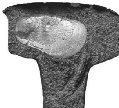
Figura 10. Fisura transversal en un riel. Fuente: Montiel Varela (2018)
