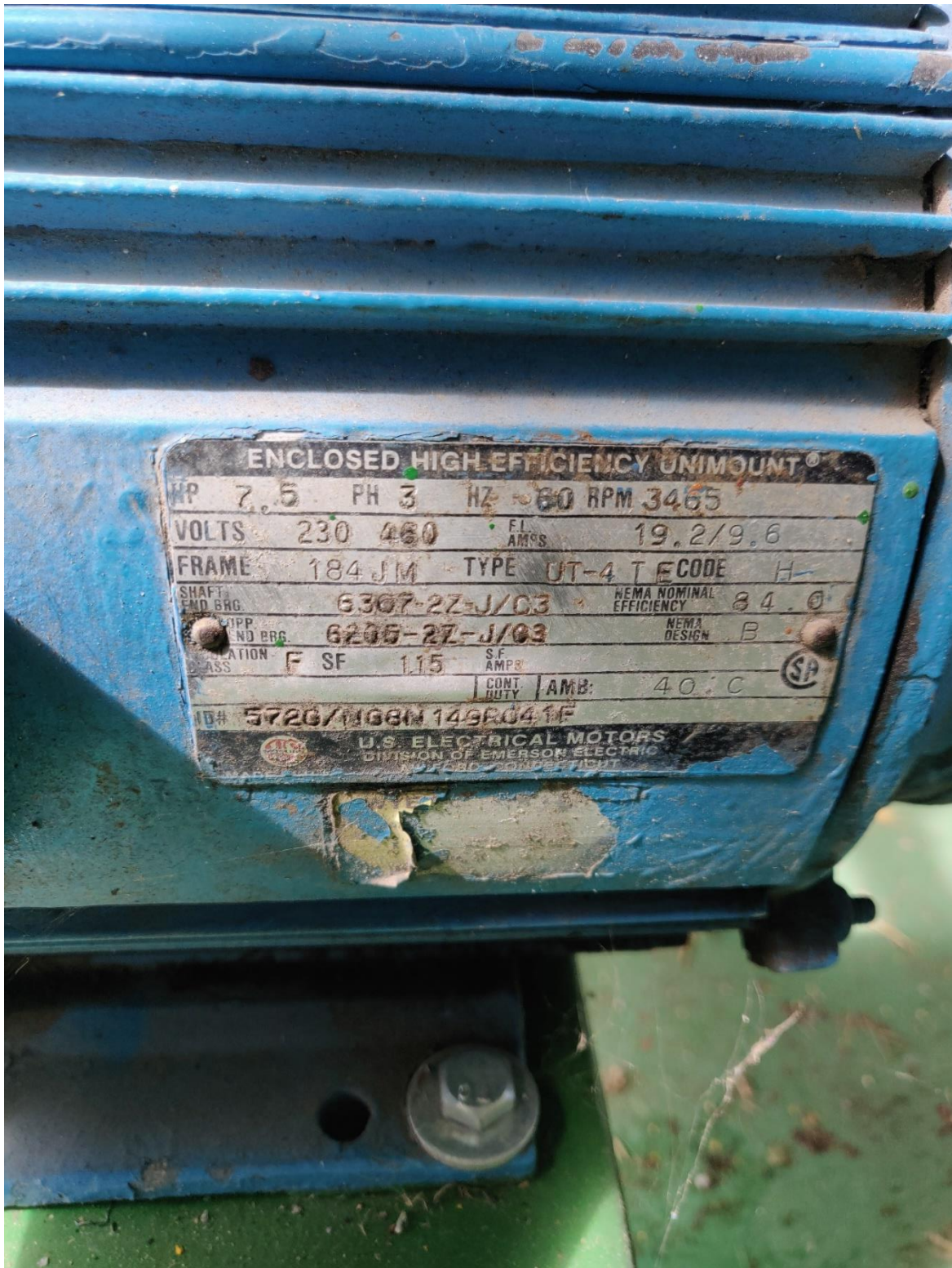
Figura 10.3 Datos de placa de motor US Electric
