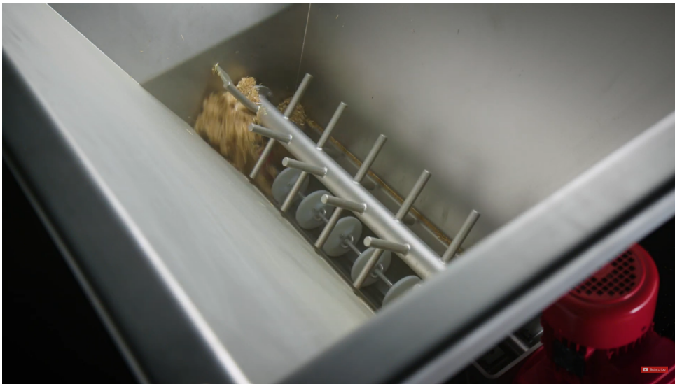
Figura 3.6: Ilustración del uso de una tolva con un transportador de cadenas de tubo para el almacenamiento y alimentación de biomasa a un reactor de combustión. [37]
