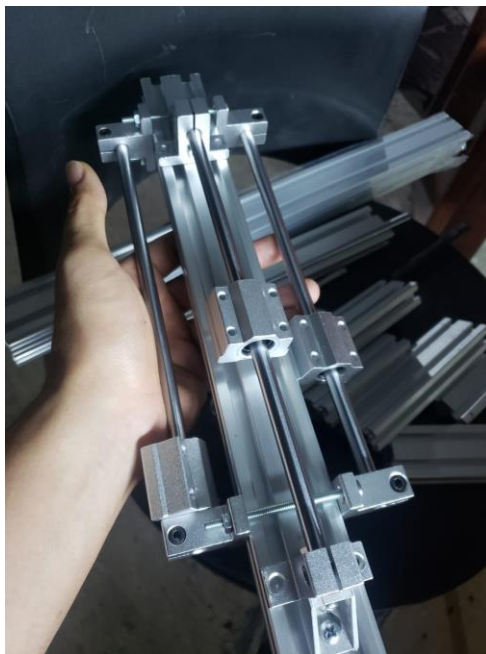
Figura 7-19. Mecanismo de movimiento eje coordenado "Z" (Elaboración propia).
