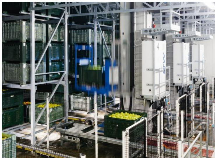
Figura 4-9. Apilador y desopilador LTW intralogistics [17].
