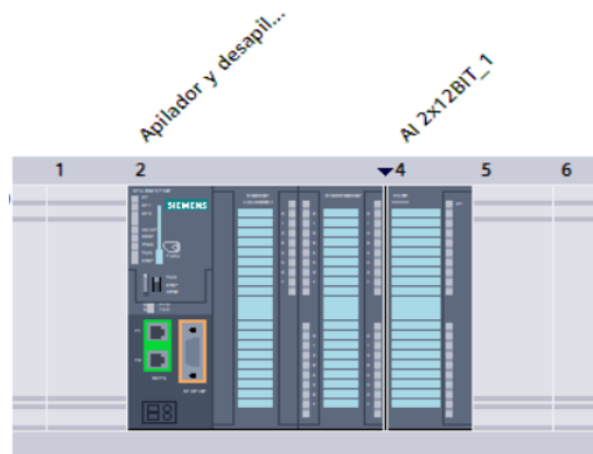
Figura 6-8. CPU del sistema de automatización (Elaboración propia).
