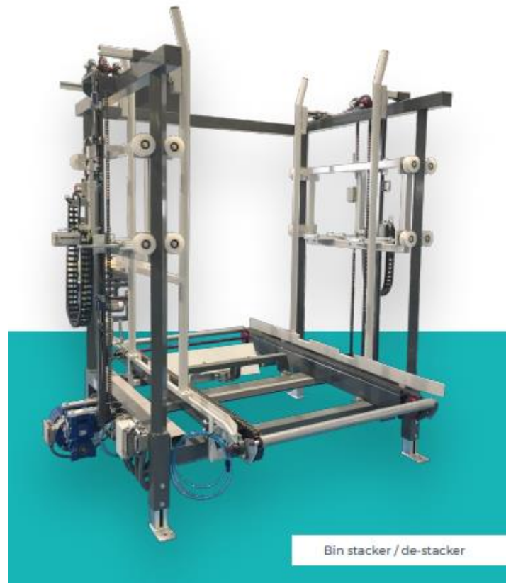
Figura 4-8. Apilador y desapilador Sienz Stacker [16].
