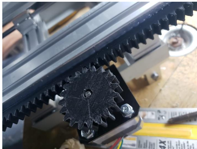
Figura 7-18. Comprobación de la funcionalidad del engranaje entre la cremallera y el piñón (Elaboración propia).
