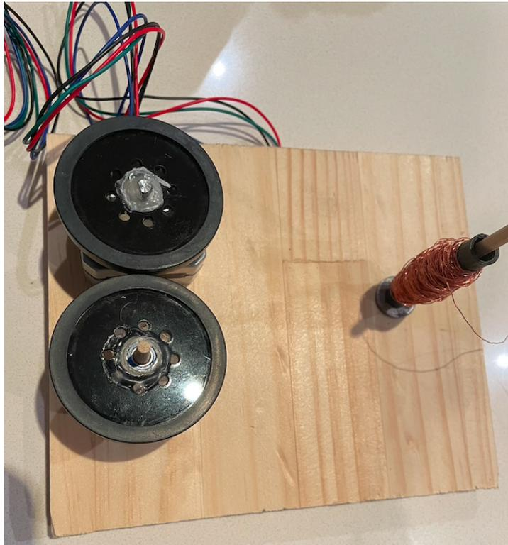
**Figura 5.9:** Prueba de concepto para comprobar funcionamiento del sistema de alimentación de cable (elaboración propia)
