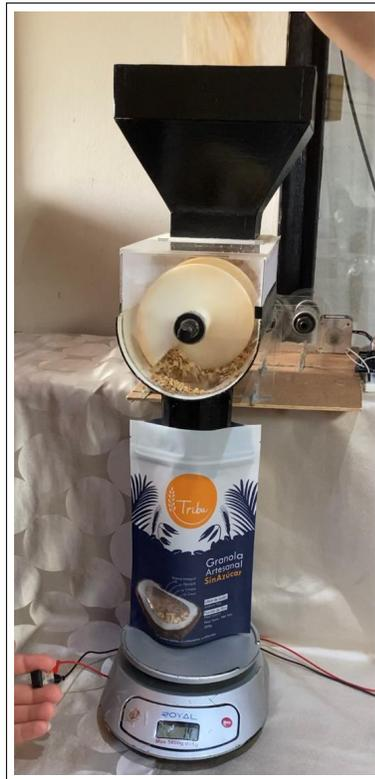
Figura 4.18: Prueba con granola sin azúcar de 300 g.
