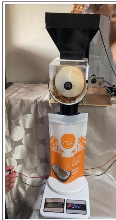
Figura 4.16: Prueba con granola original de 500 g.
