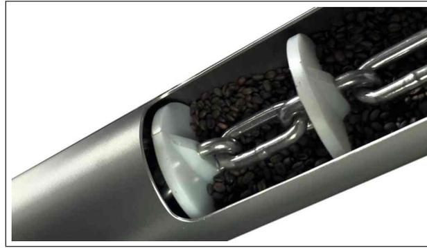
Figura 2.2: Transportador de cadena de tubo [10].
