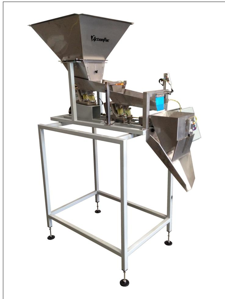
Figura 4.19: Máquina dosificadora de granola [54].
