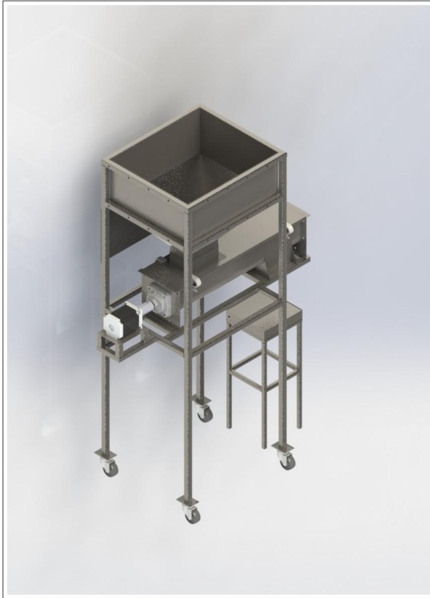
Figura 4.6: Sistema de llenado, parte trasera.
