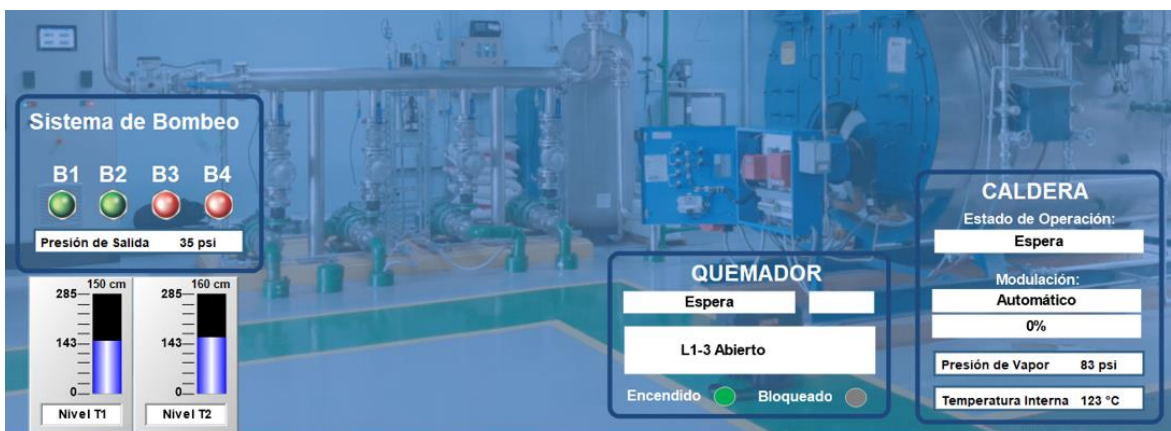
Figura 54. Pantalla general del SCADA.
