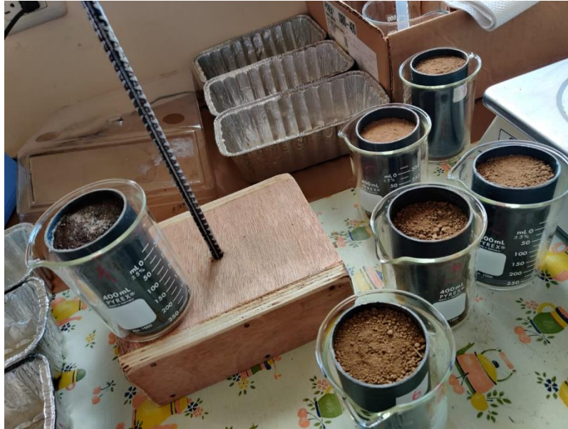
Figura 16. Muestras de suelo preparadas para la medición de humedad. Fuente propia.
