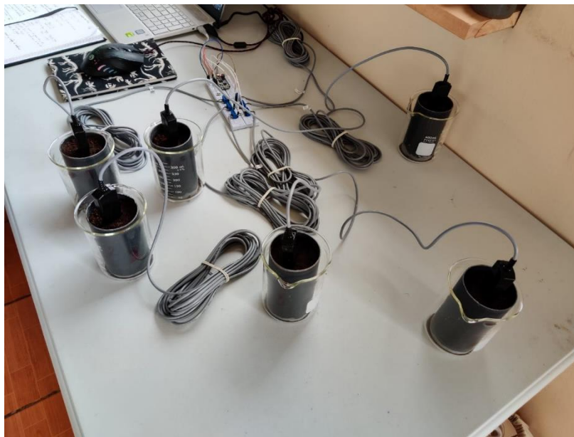
Figura 15. Mediciones de diferentes valores de humedad con los sensores Soilwatch 10. Fuente propia.
