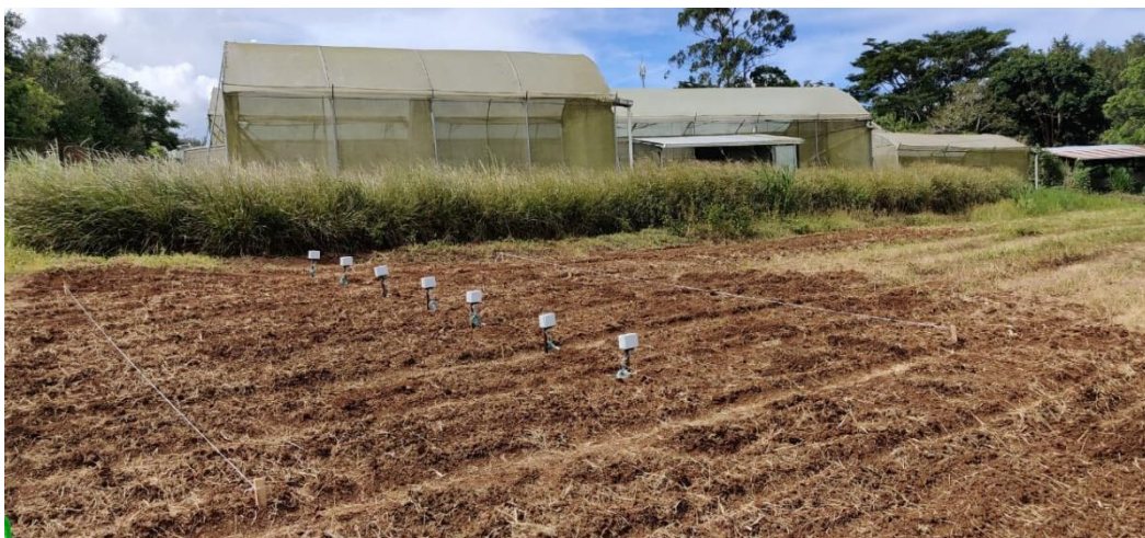
Figura 13. Área de experimentación delimitada con sensores enterrados. Fuente propia.
