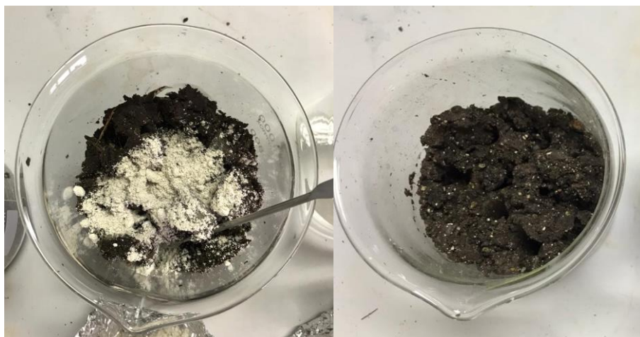
Figura 4.4. Mezcla de cal con lodo.
