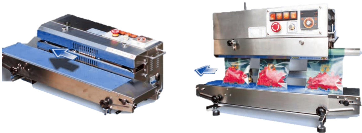
Figura 4.2. Ejemplo de sellado continuo. Fuente: (Hernández, 2013).
