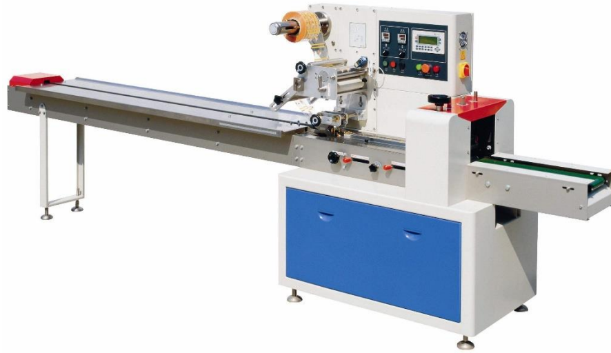
Figura 4.6. Ejemplo de empacadora y selladora horizontal. Fuente: (MAPLASCALI SAS, 2018).
