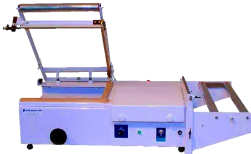
Figura 4.4. Ejemplo de sellado por alambre caliente. Fuente: (Hernández, 2013).
