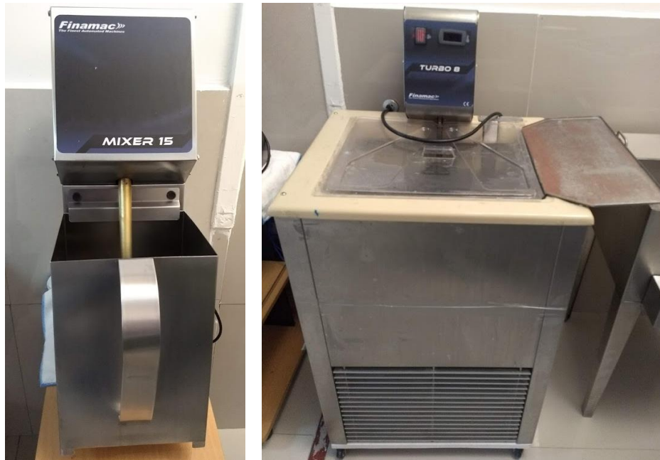
Figura 2.3. Máquina mezcladora ( Mixer 15 ) y congeladora ( Turbo 8 ). Fuente: elaboración propia.
