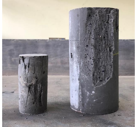
Figura 31 Patrón de falla de cilindros.
