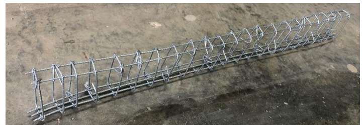
Figura 25 Refuerzo transversal y longitudinal a escala reducida
