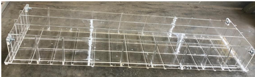
Figura 4: Moldes de acrílico para vigas de concreto reforzado a escala reducida
