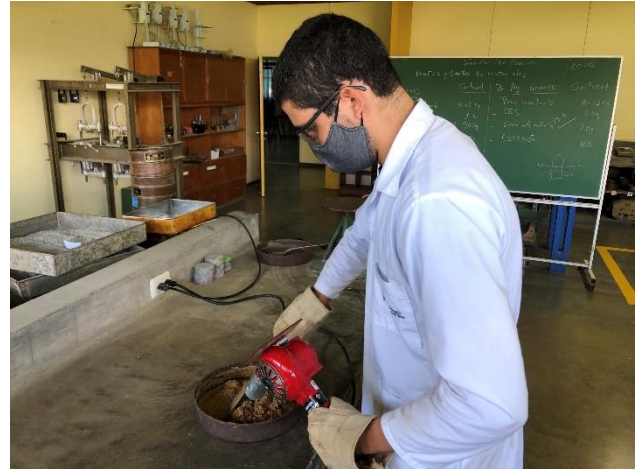
Figura 17 Proceso de eliminación del agua libre en el agregado fino
