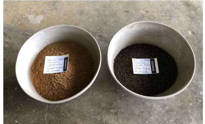
Figura 12 Muestras obtenidas a partir de la reducción en el divisor mecánico para la determinación de colorimetría.
