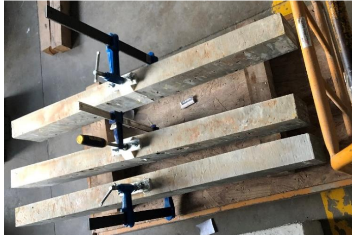
Figura 8: Colocación de dispositivos metálicos para la instalación de galgas extensométricas
