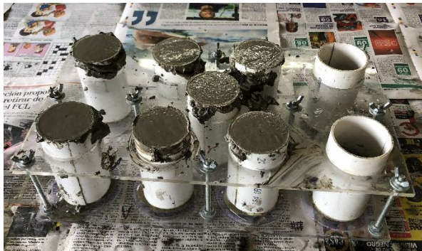
Figura 30 Colado de cilindros a escala reducida
