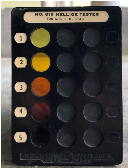
Figura 2 Escala Gardner para ensayo de colorimetría
