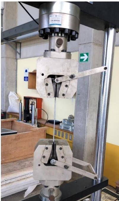
Figura 21 Ensayo de tracción a los alambres galvanizados
