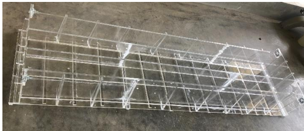
Figura 23 Moldes de acrílico para vigas a escala reducida
