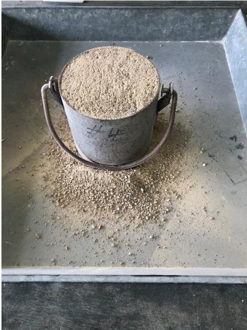
Figura 19 Proceso de enrasado para determinación de peso unitario suelto.
