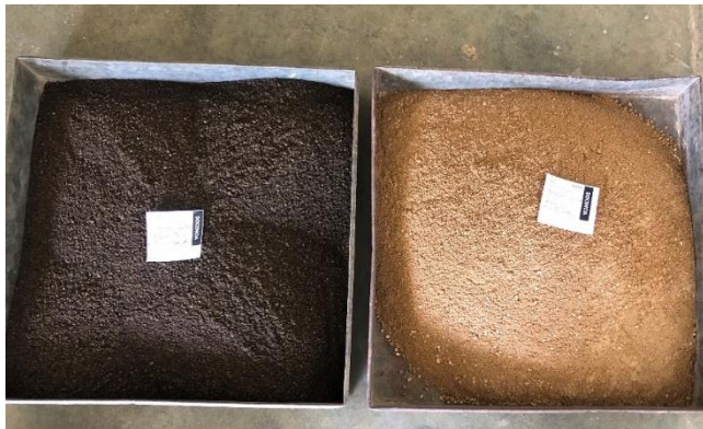
Figura 11 Muestras obtenidas a partir de la reducción en el divisor mecánico para la determinación de pesos unitarios.
