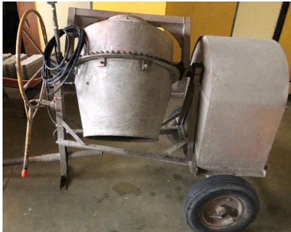
Figura 27 Batidora utilizada para la mezcla de microconcreto.
