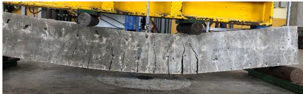
Figura 34 Grietas generadas en las vigas debido a la aplicación de carga
