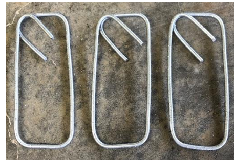
Figura 24 Refuerzo transversal a escala reducida
