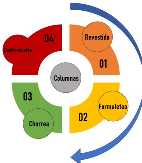
Figura 32. Ciclo de construcción de columnas Fuente: Elaboración propia
