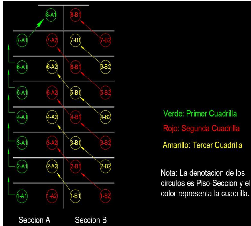
Figura 36. Escenario 3 de 1.5 cuadrillas de encofrado de entrepiso en el edificio D. Fuente: Elaboración propia
