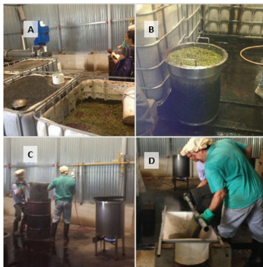
Figura 1. Proceso de escaldado de la pimienta. (A) Pimienta en tanqueta de agua, (B) extracción de pimienta (25 kg) para escaldar, (C) Inmersión de la pimienta en agua caliente a 80°C, (D) Escurrido de la pimienta, una vez finalizado el proceso de escaldado.
