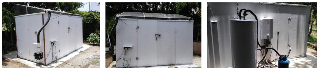
Figura 3. Prototipo de secador solar desarrollado por el Grupo de Investigación en Sistemas Térmicos Solares para la Agricultura, Sede Regional San Carlos, Instituto Tecnológico de Costa Rica.
