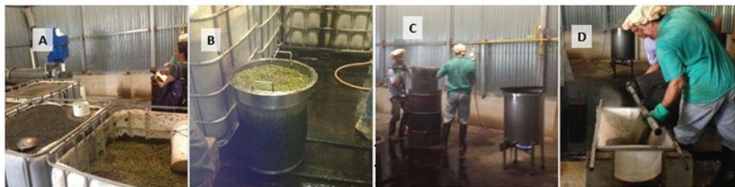
Figura 17. Proceso de producción de pimienta negra en la planta de APROPISA. (A) Pimienta verde almacenada en contenedores plásticos con agua. (B) Canastas metálicas con pimienta verde (25 kg) lista para ser escaldada. (C) Introducción y retiro de las canastas metálicas en los contenedores con agua a 80°C. (D) Escurrido de la pimienta tras el escaldado. Fuente: Elaboración propia.
