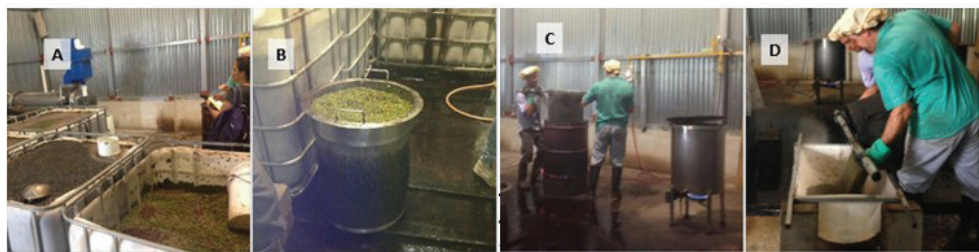
Figura 1. Proceso de producción de pimienta negra en la planta de APROPISA. (A) Pimienta verde almacenada en contenedores plásticos con agua. (B) Canastas metálicas con pimienta verde (25 kg) lista para ser escaldada. (C) Introducción y retiro de las canastas metálicas en los contenedores con agua a 80°C. (D) Escurrido de la pimienta tras el escaldado. Fuente: Elaboración propia.
