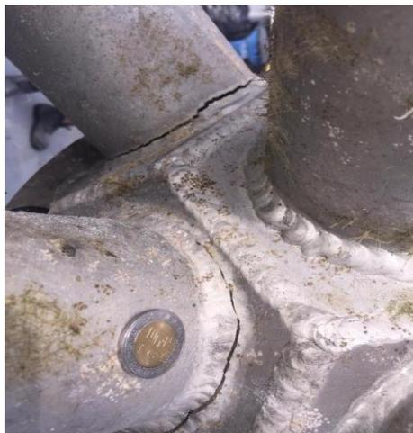
Figura 5.25 Grieta longitudinal sobre soldadura en el candelabro (CICESE, 2019).
