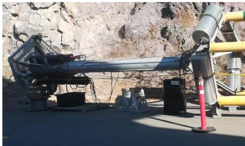
Figura 4.8 Estructura inferior y candelabro de la BOMM (CICESE, 2019).
