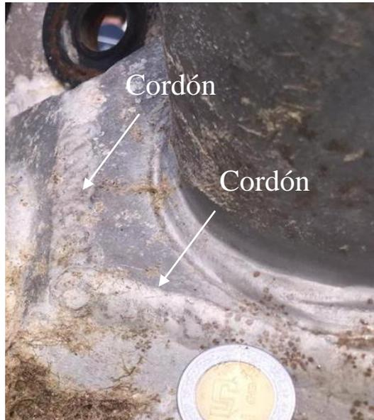
Figura 3.14 Soldadura a tope en aleación de aluminio 6061.
