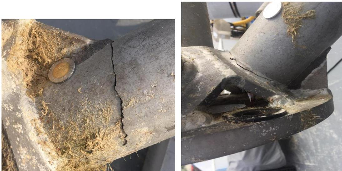
Figura 2.3 Fracturas en candelabro de la BOMM-VER-2. Izquierda: Componente cilíndrico. Derecha: Falla en soldadura (CICESE, 2020).
