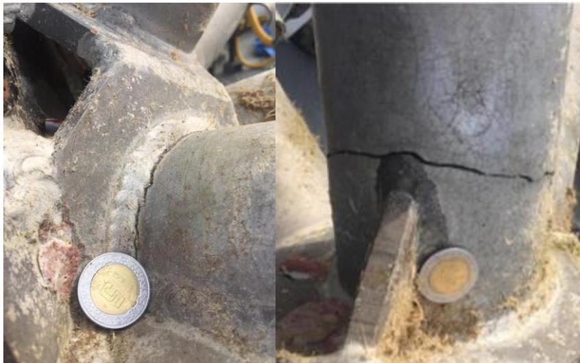
Figura 5.23 Grietas adyacentes al cordón de soldadura en el candelabro.
