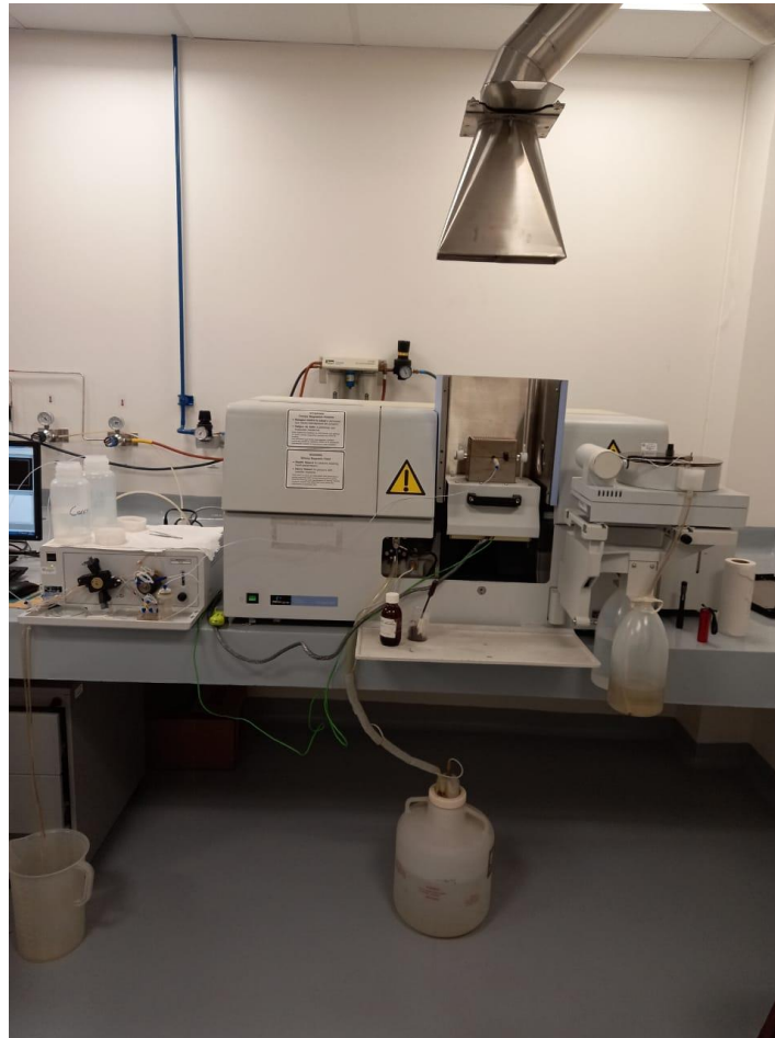
Figura 3.4 Espectrómetro de absorción atómica marca Perkin-Elmer modelo AAAnalyst-800.
