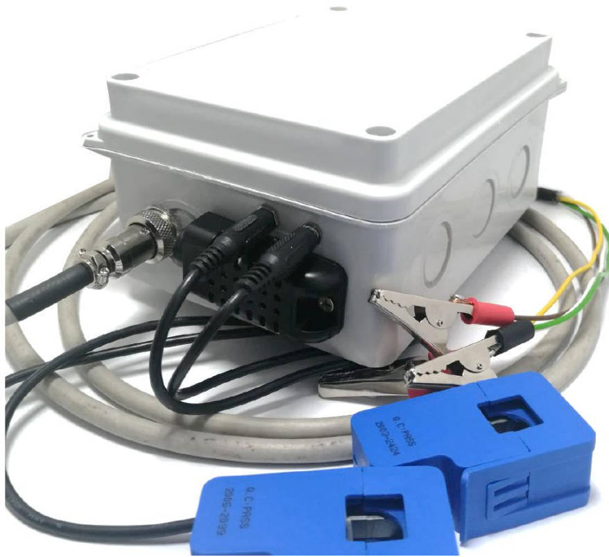
Figura 10.2.12 Medidor de condición de sobrecarga Elaboración propia.
