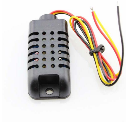
Figura 10.2.8 Modulo DTH21 AM2301 Fuente: Adafruit.com
