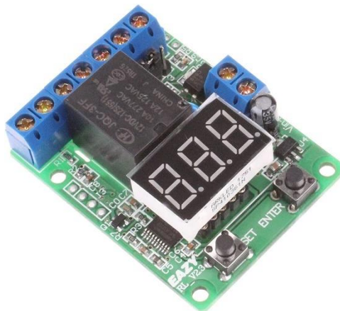
Figura 4. 18 Circuito de desconexión. [73]
