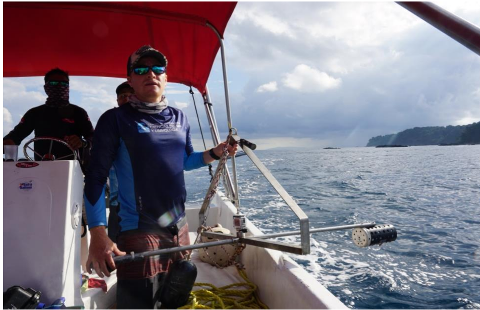
Figura 2.1 BRUVS listo para ser colocado en un punto de muestreo. Fuente: CIMAR UCR
