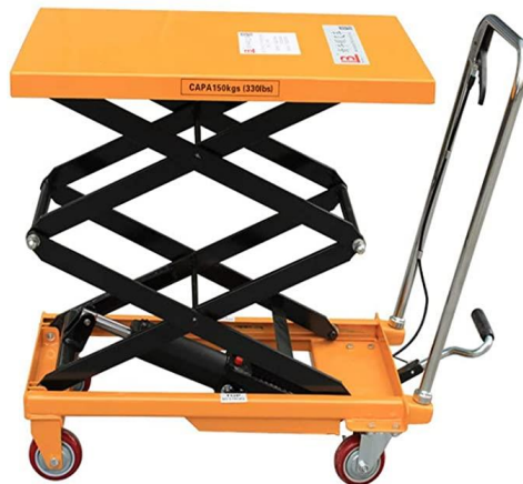
Figura 7-14 Mesa hidráulica tipo tijera
