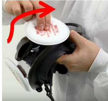
Figura 4-17. Colocación de los filtros
