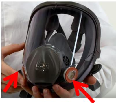
Figura 4-16. Empaquetaduras de respirador de cara completa
