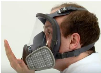
Figura 4-20. Prueba de ajuste positiva de respirador de cara completa
