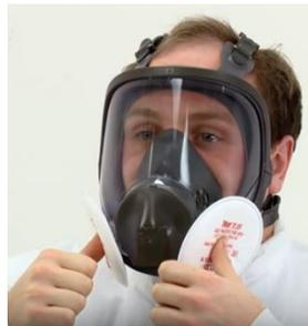
Figura 4-21. Prueba de ajuste negativa de respirador de cara completa
