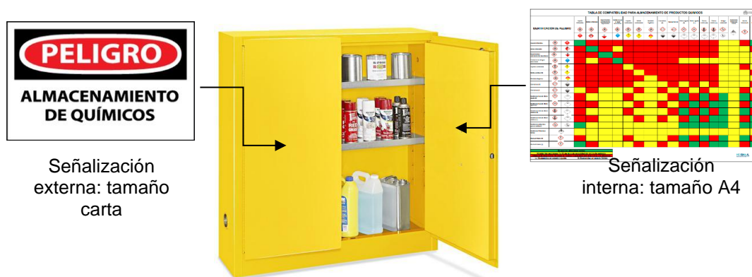
Figura 114. Señalización del gabinete para compatibilidad en el almacenamiento de sustancias peligrosas y material combustible
