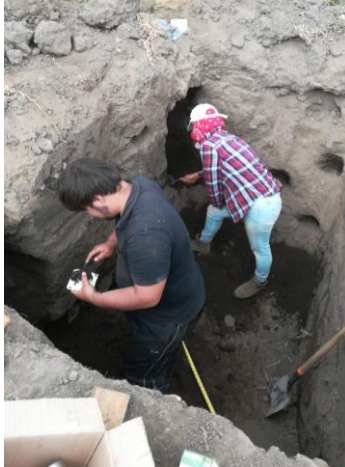
Figura 4. Extracción de muestras de suelo intacto en cilindros.
