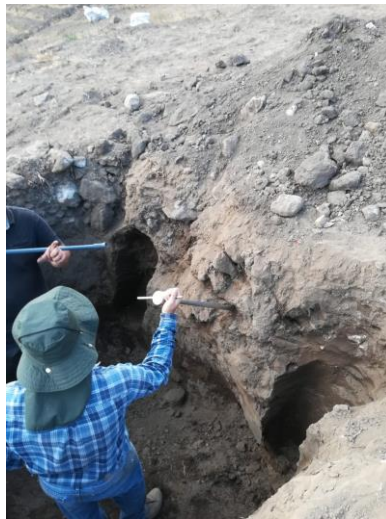
Figura 7. Instalación de lisímetro.
