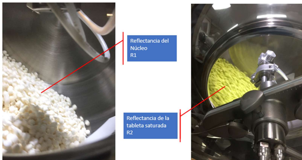
Figura 53. Imágenes de las tabletas en el bombo de recubrimiento. (Iz) Núcleos sin recubrir y (Der) tabletas a los 190 min de recubrimiento (mezcla de Azul FD&C N° 1 y Amarillo Tartrazina).
