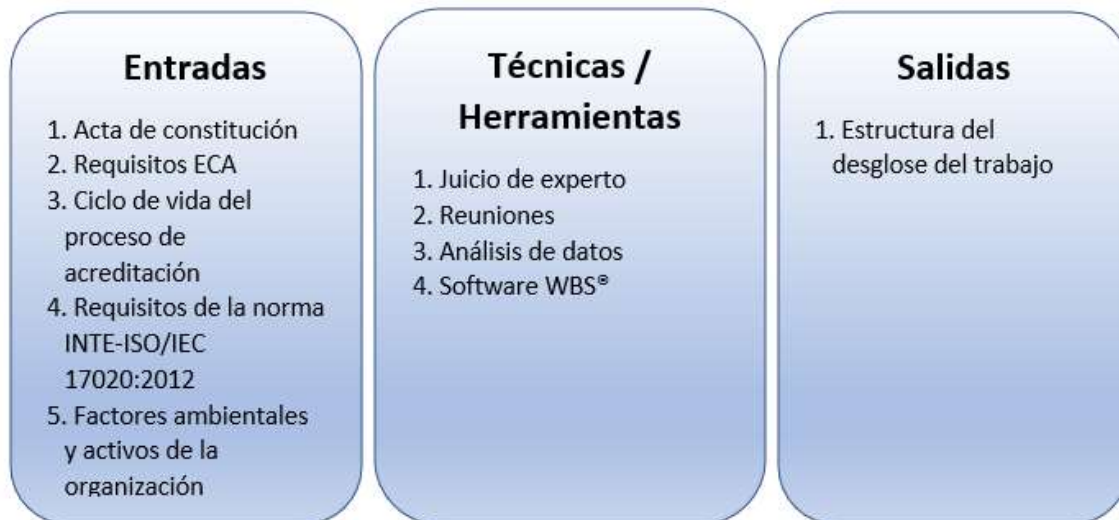
Figura 5.4: Flujo de proceso para el desarrollo de la estructura de desglose del trabajo
