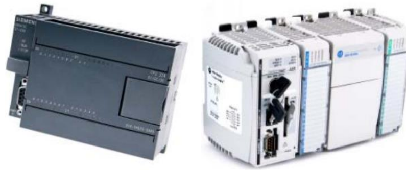
Figura 2-10. PLC compacto(izquierda) y modular(derecha). Fuente: [24].
