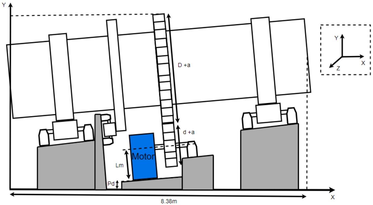
Figura 5-38. Esquema y dimensiones finales de la secadora propuesta. Fuente: Elaboración propia.
