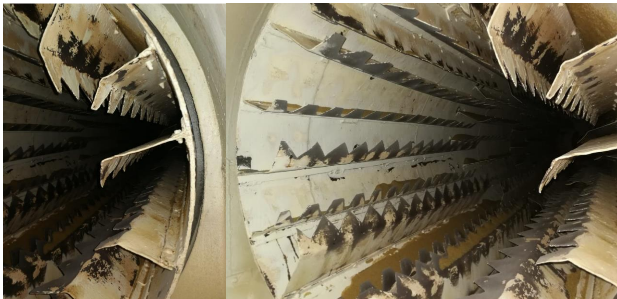
Figura 3-10. Paletas o elevadores internos. Fuente. Coopevictoria R.L.
