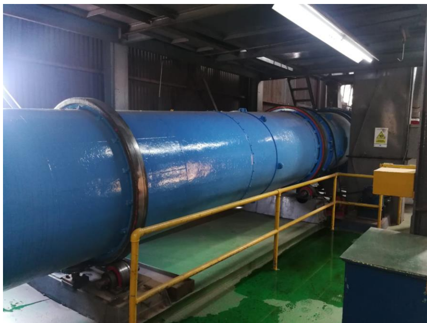
Figura 1-2. Secadora de azúcar actual. Fuente: Coopevictoria R.L.
