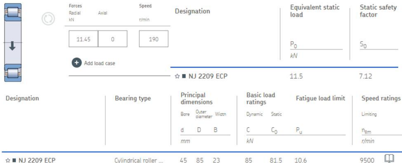
Figura 5-11. Características y cálculo del cojinete NJ 2209 ECP. Fuente: [65].
