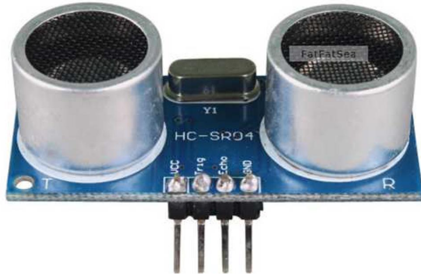
Figura 34. Módulo HC-SR04. Fuente: Adaptado de [13].
