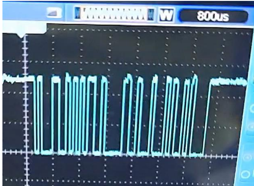
Figura 122. Visualización del tren de pulsos enviados por el ATmega 328p hasta la Raspberry Pi 4. Fuente: elaboración propia.
