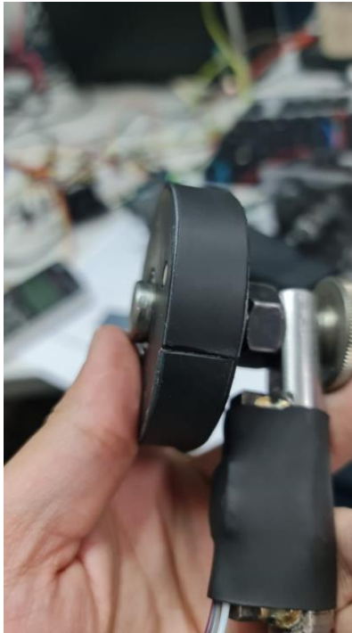
Figura 119. Adición de la cinta de caucho alrededor de la rueda. Fuente: elaboración propia.
