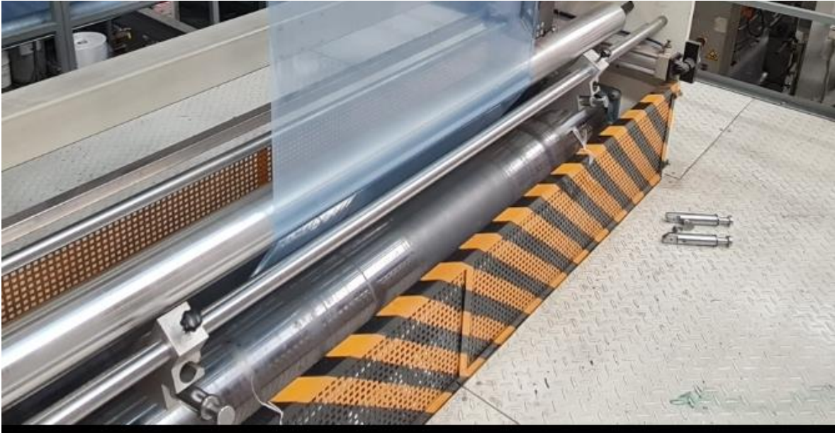
Figura 5. Las cuchillas se pueden observar a los lados de la filmina. En este caso no se están utilizando. Fuente: Elaboración propia.
