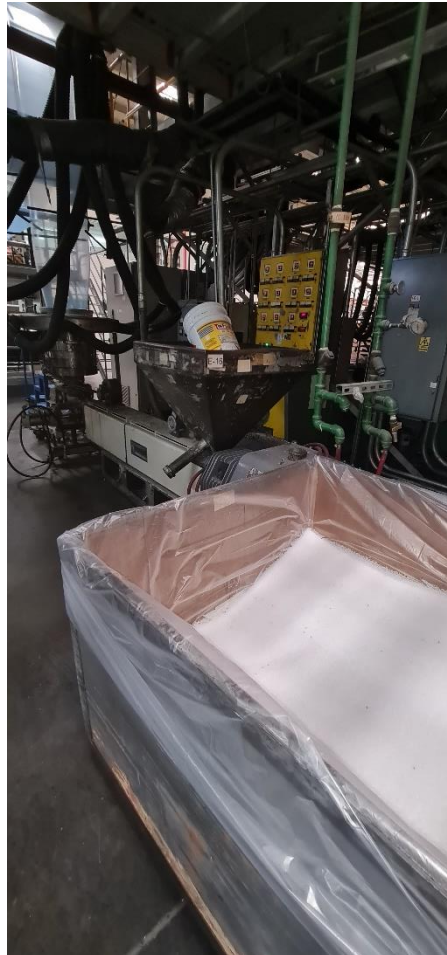
Figura 1. Tolva (al fondo) y resina granulada (al frente). Fuente: Elaboración propia.
