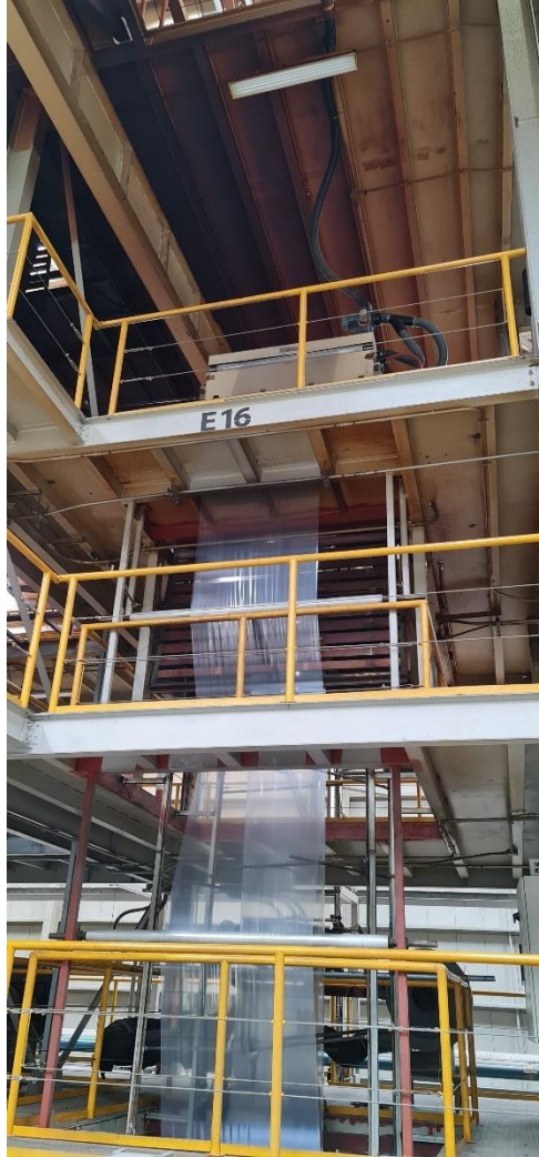
Figura 3. Prensa superior (arriba), globo (atrás), lámina (frente). Fuente: Elaboración propia.
