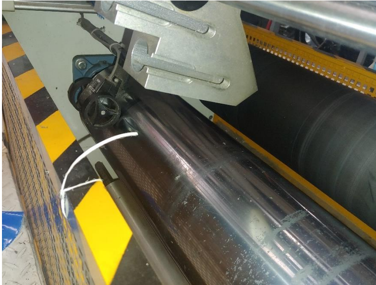
Figura 4. Rodillo de presión y contador de pasos. Fuente: Elaboración propia.
