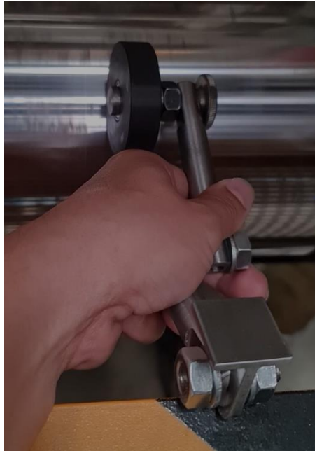
Figura 118. Prueba preliminar de fricción entre la rueda y el rodillo de presión. Fuente: elaboración propia.
