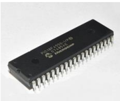
Figura 48. PIC4550. Fuente: adaptado de [16]
