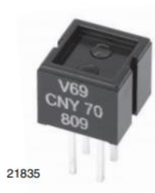
Figura 46. Sensor CNY70. Fuente: adaptado de [22].
