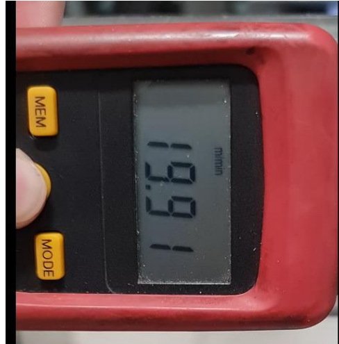
Figura 126. Tacómetro digital de mano utilizado. Fuente: elaboración propia.
