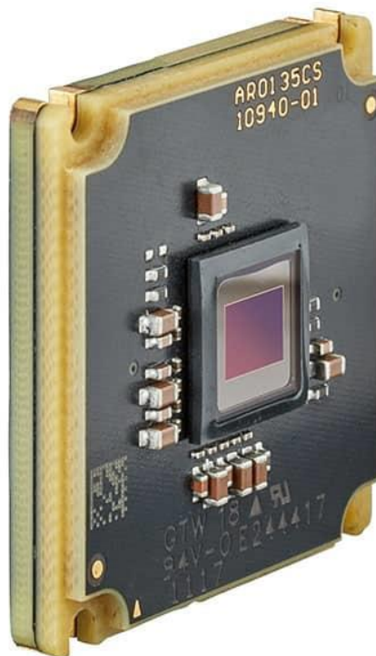
Figura 42. Sensor matricial 11484. Fuente: adaptado de [18].
