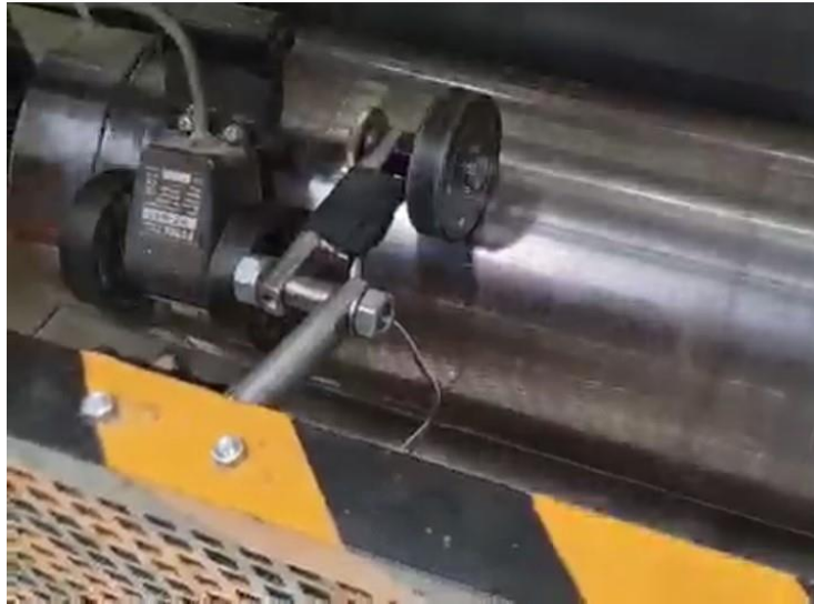
Figura 120. Rueda de imanes en la posición final. Fuente: elaboración propia.
