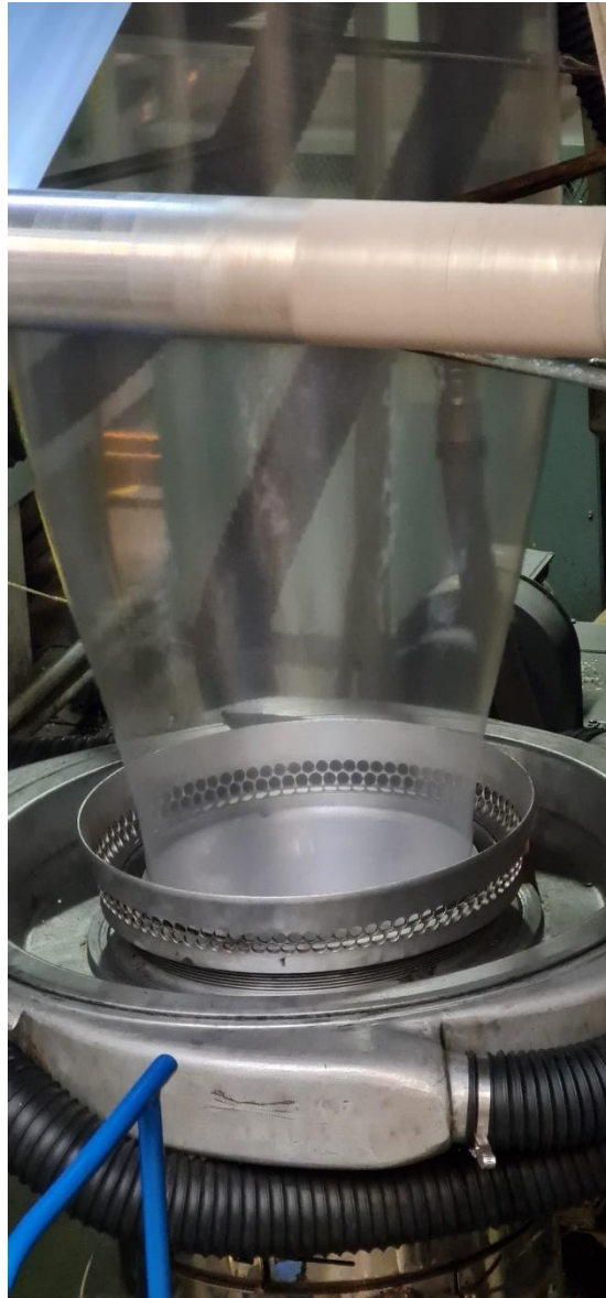
Figura 2. Etapa de soplado del plástico fundido. Fuente: Elaboración propia.
