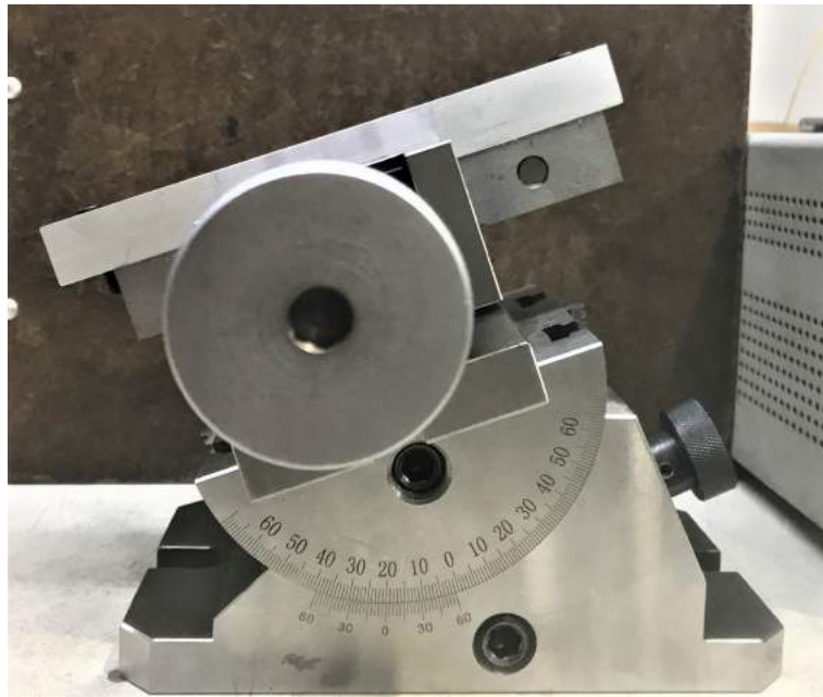
Figura 3.6: Prensa de Senos sujetando pieza de prueba.
