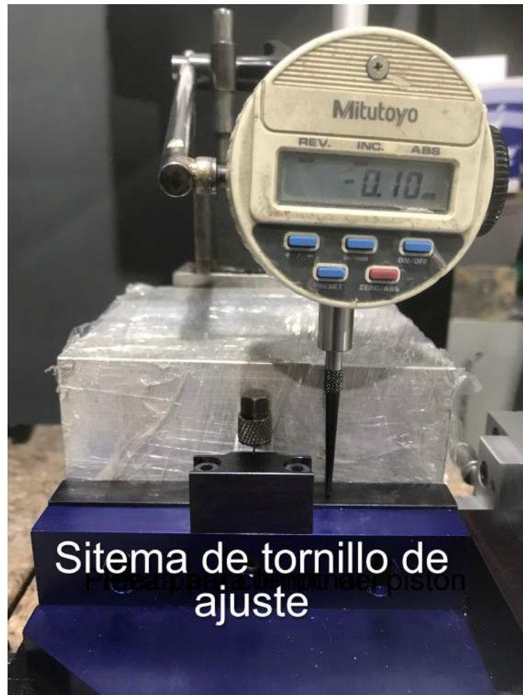
Figura 5.2: Comparador de alturas con pieza para las pruebas de tornillo de ajuste.
