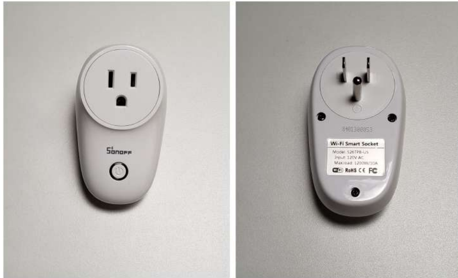
Figura 5.1: Sonoff S26 Smart Plug para aplicación piloto. Fuente: elaboración propia
