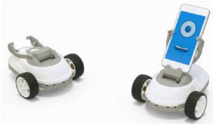
Figura 2.1: Robobo con su base y aplicación móvil. Recuperado de: [8]
