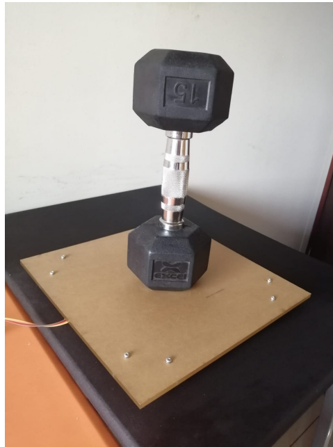
Figura 5.7: Prueba de concepto de medición de peso. Fuente: Elaboración propia
