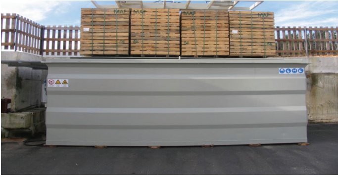
Figura 3. Tanque industrial de inmersión para piezas de madera despuntada.
