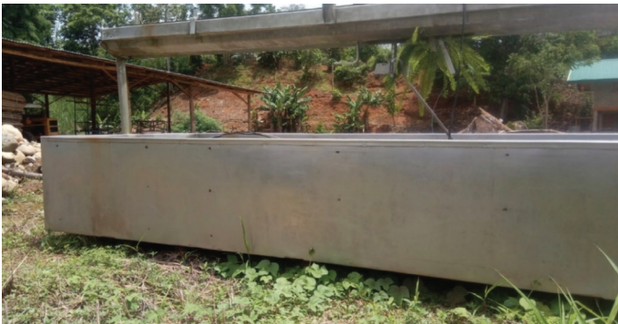
Figura 4. Tanque para inmersión de piezas cortas de madera hecho a partir de un tanque de enfriamiento de una lechería (Maderas S&Q).
