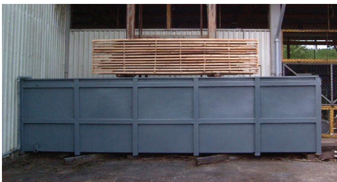
Figura 2. Tanque industrial de inmersión para piezas largas de madera.
