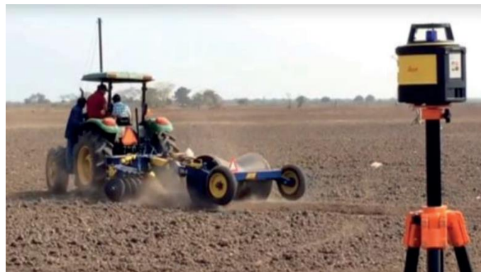
Figura 3.6. Nivelación láser y composición de taipas en arroz
