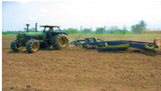
Figura 3.4. Lote a micronivelación con multicuchillas Landplane
