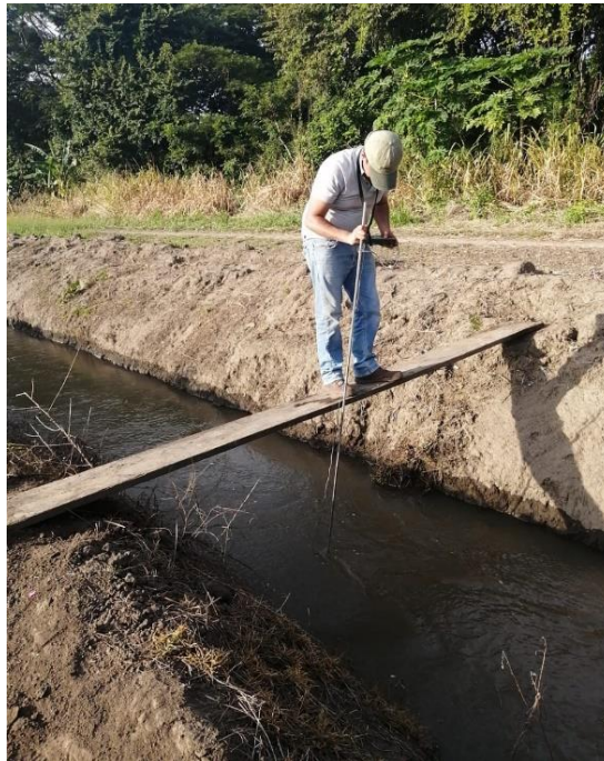
Anexo 7. Actividad de aforo con correntómetro en canal abierto de tierra
