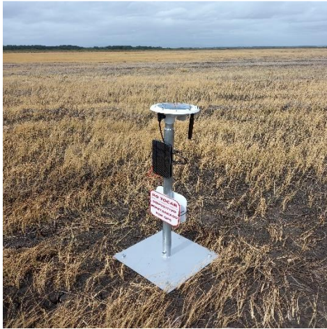
Figura 4.5. Monitor de cultivo Mark 2 - Arable
