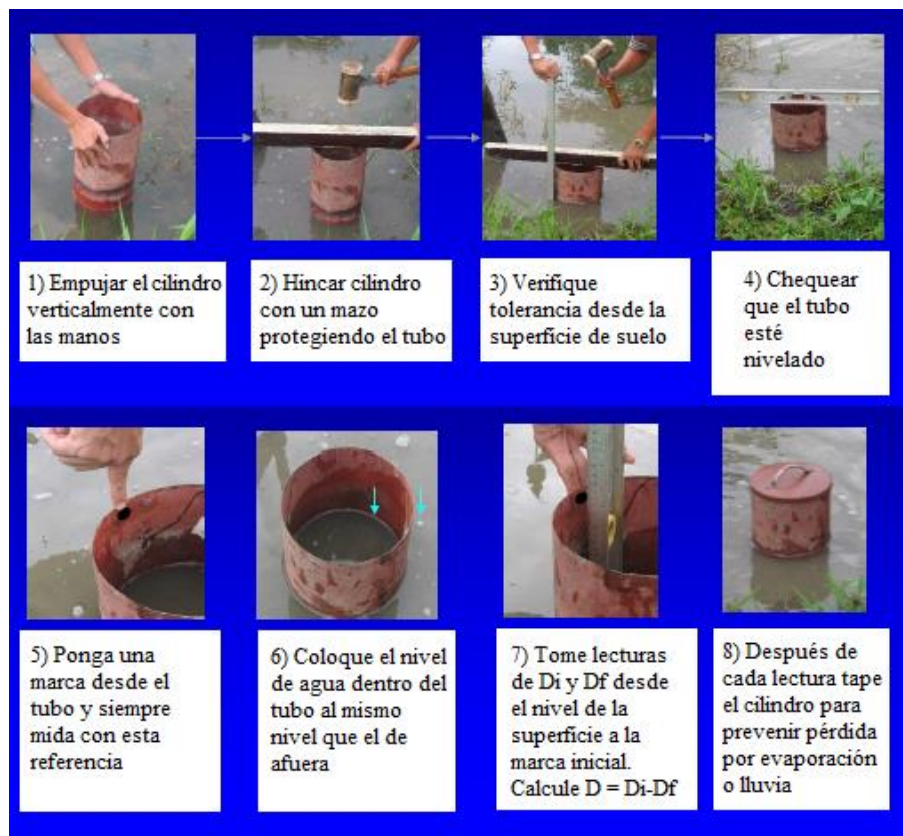
Figura 9.1. Metodología de instalación y uso del anillo de percolación
