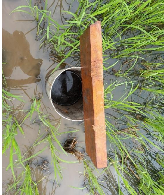
Figura 9.2. Preparación del anillo de percolación en campo
