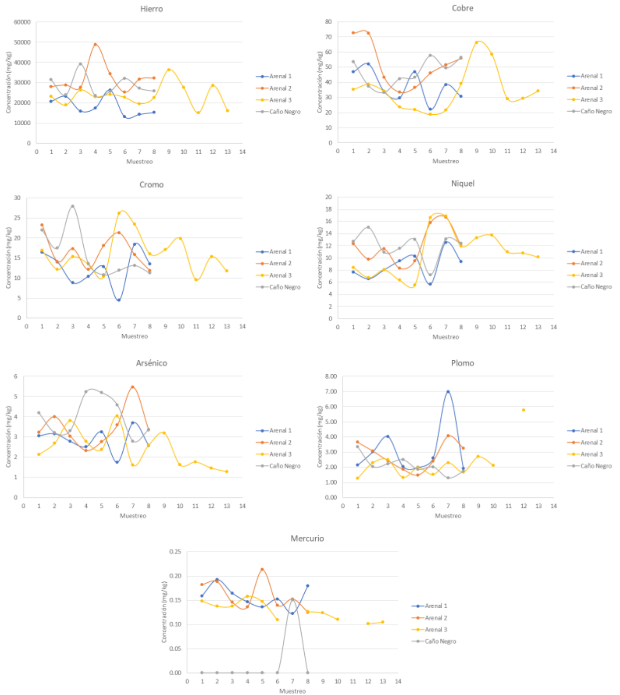
Figura 8.1. Distribución de las concentraciones de MP a lo largo de los muestreos para el Río Arenal.
