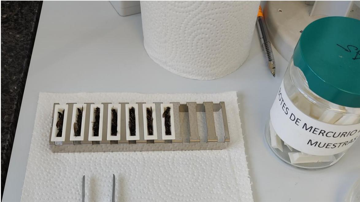
**Figura 4.6 Muestras de moscas colocadas para su medición en los pocillos de muestra.**
