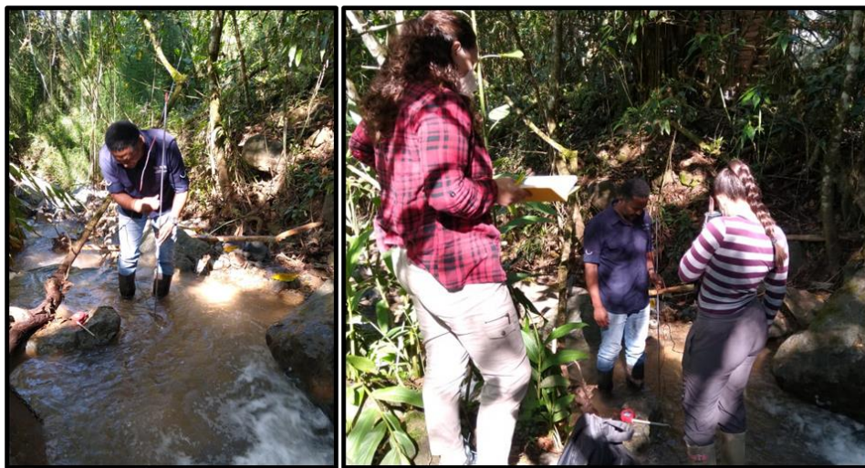
Figura. A.6.4. Registro fotográfico de aforo de caudal por Método del Molinete en punto
