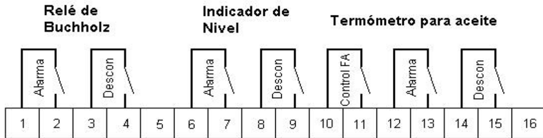
Figura 6.4 Detalle de los contactos presentes en la caja de bornes del transformador.
