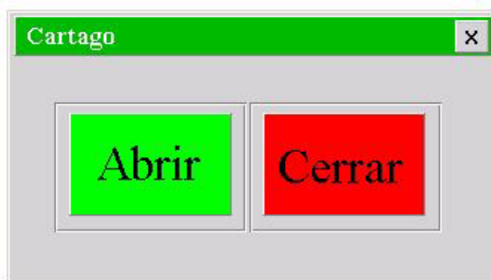
Figura 5.23 Pantalla de control de reanectadores
