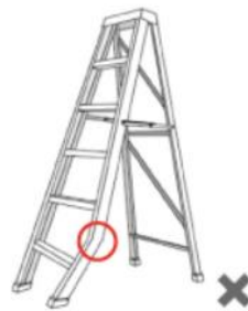
Figura 10. Escalera en mal estado. (Marín Cornavaca, 2021)
