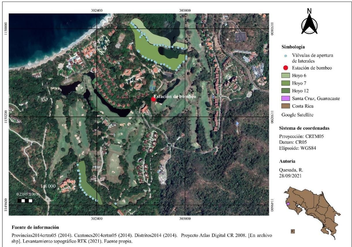
En el Anexo 5 se muestran las elevaciones de cada una de las válvulas y la estación de bombeo, dichos datos serán necesarios para la modelación hidráulica de la tubería principal en el programa EPANET.
