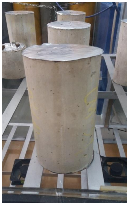
Figura 3.2. Cilindro de concreto fabricado con cemento tipo MP/A-28 [Ara19].
