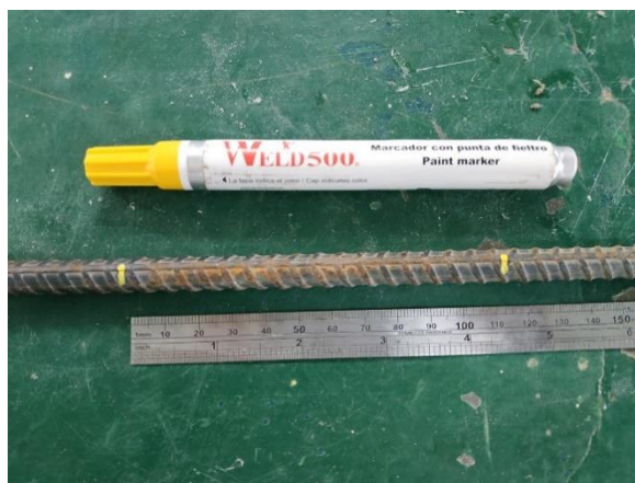
Figura 3.5. Preparación de las varillas de acero para confección de probeta de análisis [Nog18].
