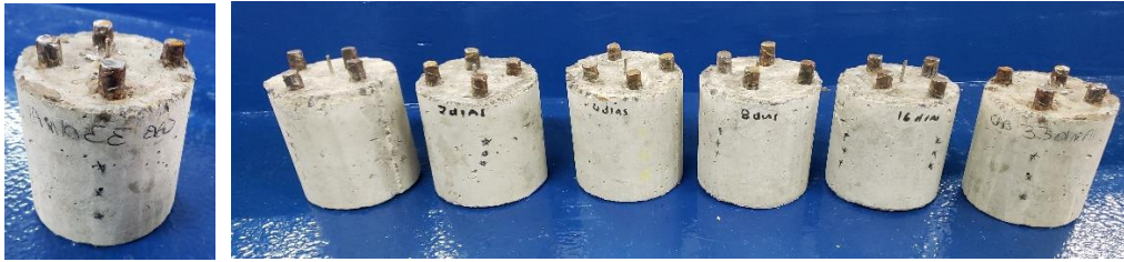
Figura 3.10. Sitios de medición de potenciales de media celda.
