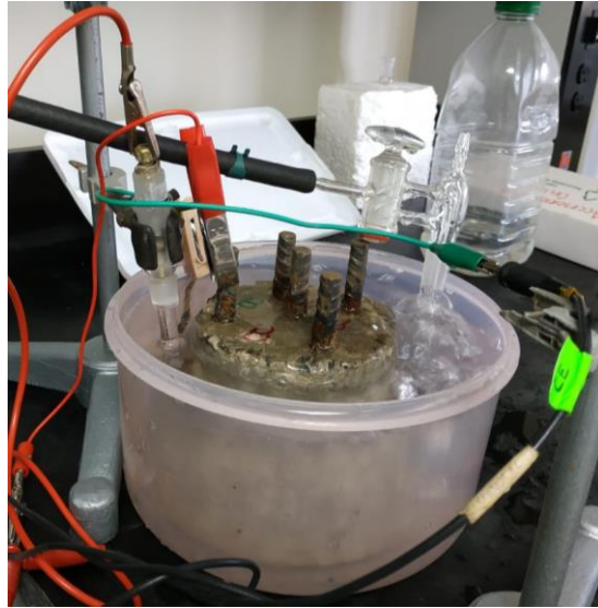
Figura 3.9. Celda de trabajo para la resistencia a la polarización y la espectrometría de impedancia electroquímica.
