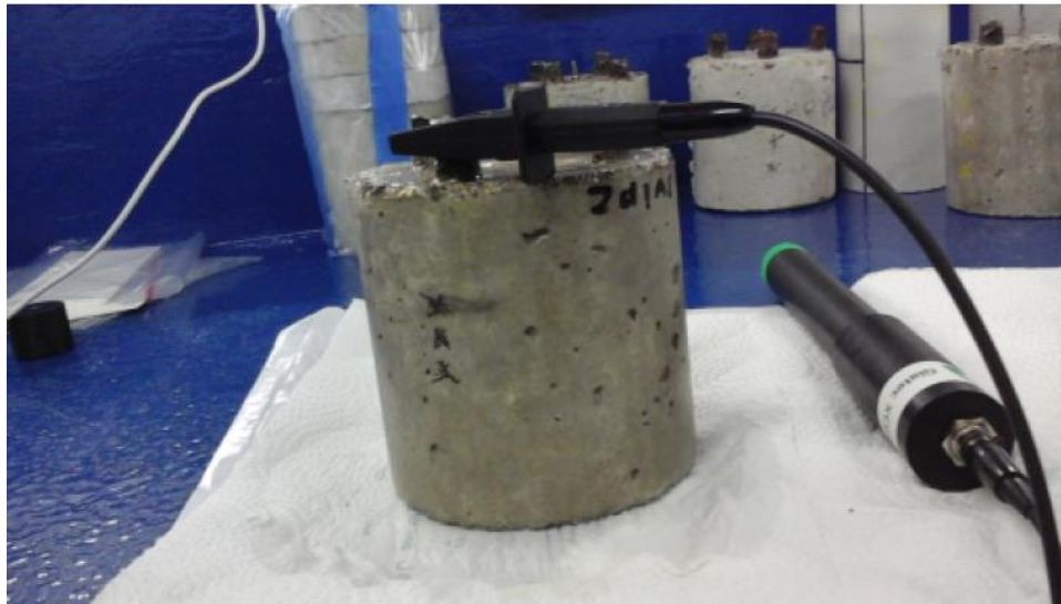
Figura 3.31. Muestra de concreto durante el ensayo de potencial de media celda.
