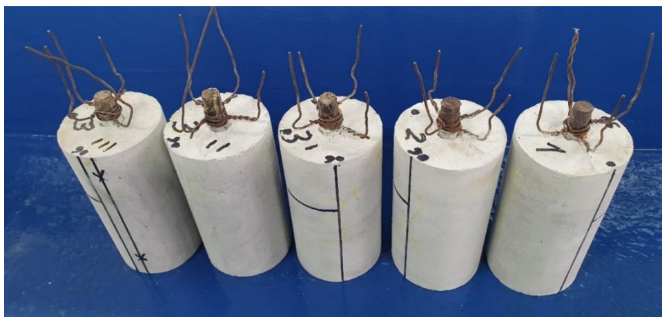
Figura 3.35. Especímenes de cemento reforzado para las mediciones no destructivas.
