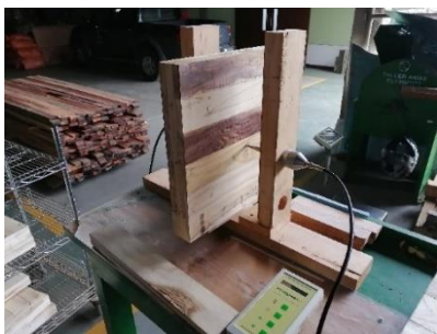
Figura 1. A. Procedimiento para medir la velocidad de onda ultrasónica con el equipo SILVATEST DUO en CLT/ T. grandis perpendicular a la cara principal. B. Estimación del contenido de humedad con higrómetro en CLT/ G. arborea
