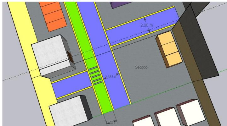
Figura 11. Propuesta de las dimensiones de los pasillos de las áreas de secado, doblado y planchado
