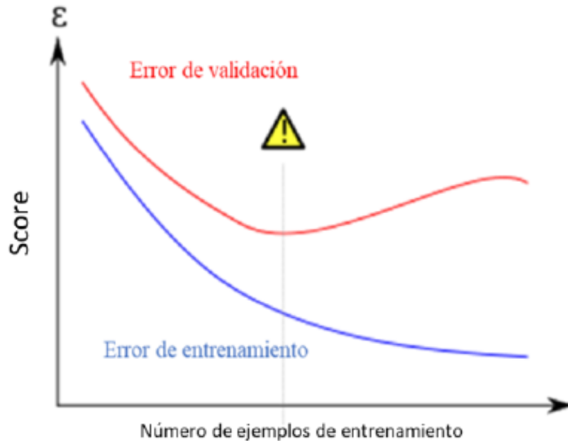
Figura 2.6: Curva de aprendizaje con presencia de sobreajuste. Obtenido de [1].
