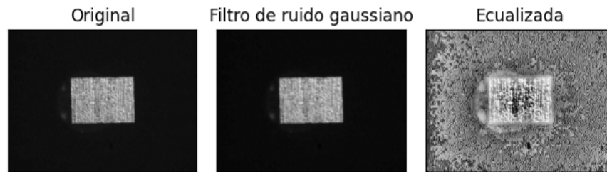
Figura 5.8: Procesamiento de la imagen con filtro gaussiano y ecualización. Elaboración propia.
