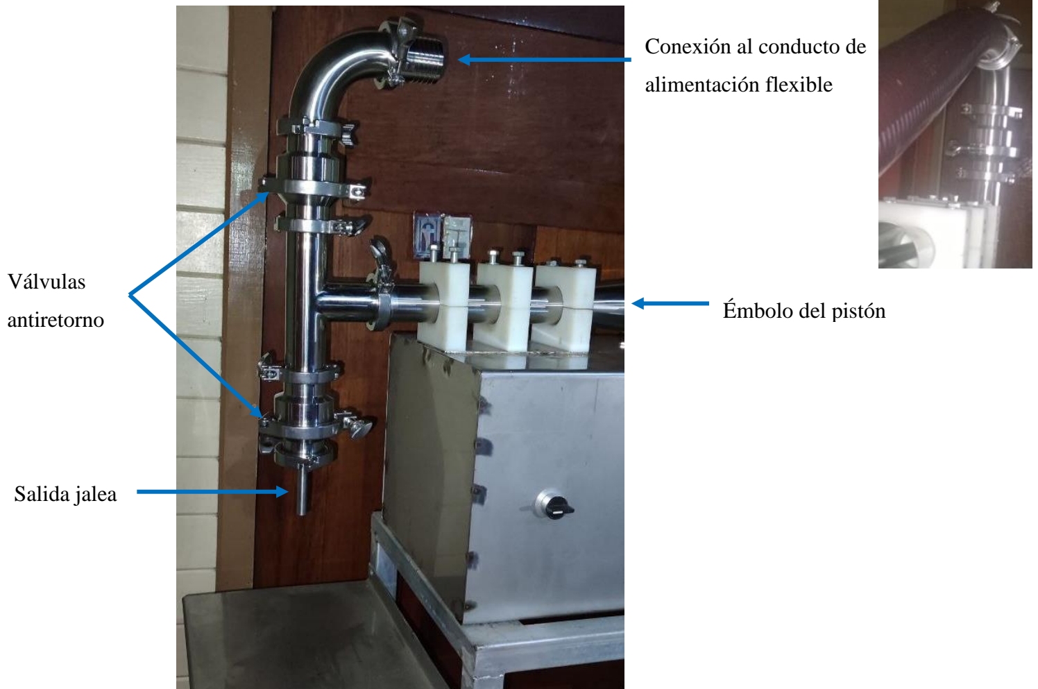
Figura 3.2. Conductos de abastecimiento de acero inoxidable. Fuente: Elaboración propia.
