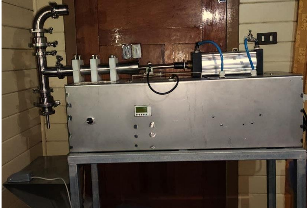
Figura 3.1. Máquina llenadora de la empresa. Fuente: Elaboración propia.
