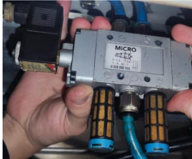
Figura 3.12. Electroválvula direccional 5/2 de la máquina actual. Fuente: Elaboración propia.
