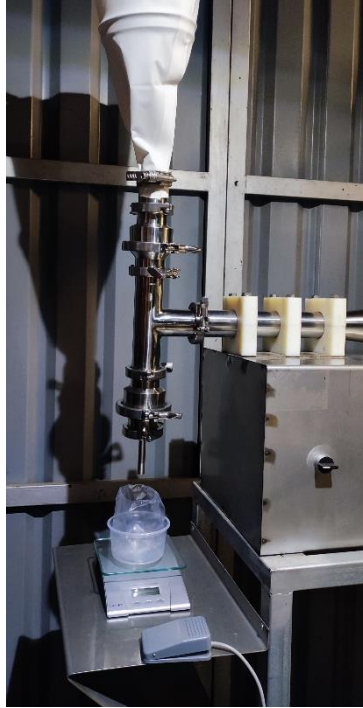
Figura 9.2. Tolva y conductos utilizados durante las pruebas de validación. Fuente: Elaboración propia.
