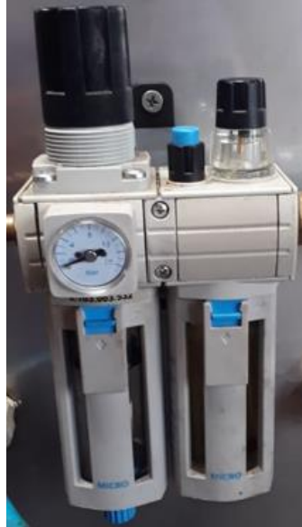
Figura 3.11. Unidad de preparación de aire de la máquina actual. Fuente: Elaboración propia.
