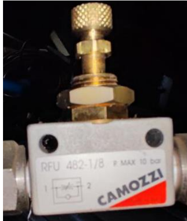
Figura 3.13. Válvula de control de flujo de la máquina actual. Fuente: Elaboración propia.
