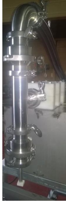
Figura 3.4. Sujeción de la manguera a la máquina. Fuente: Elaboración propia.
