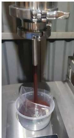
Figura 9.3. Llenado de 500 g de jalea. Fuente: Elaboración propia.
