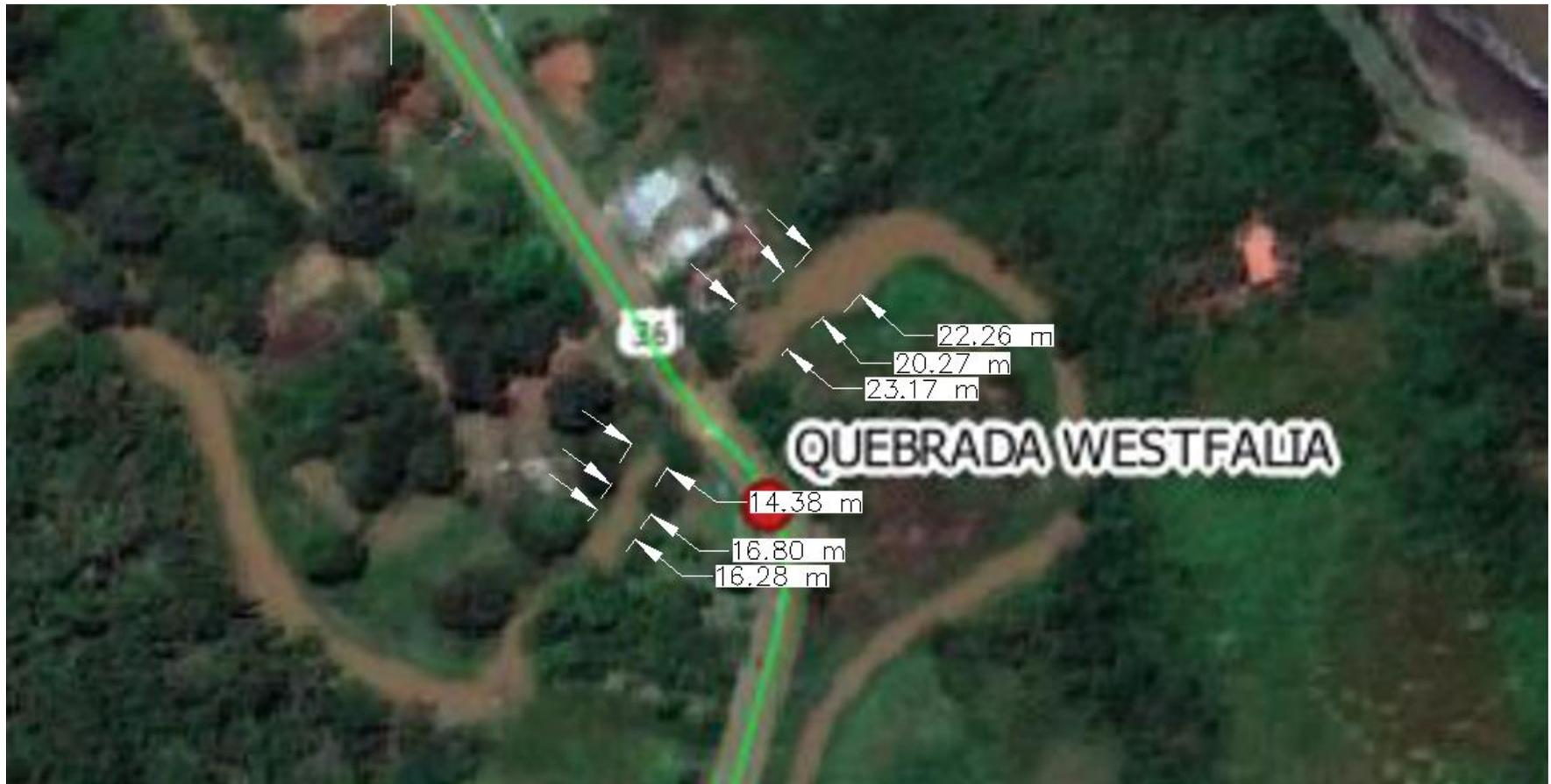
**Ilustración 37:** Revisión de ancho del cauce Puentes sobre la Quebrada Westfalia.
