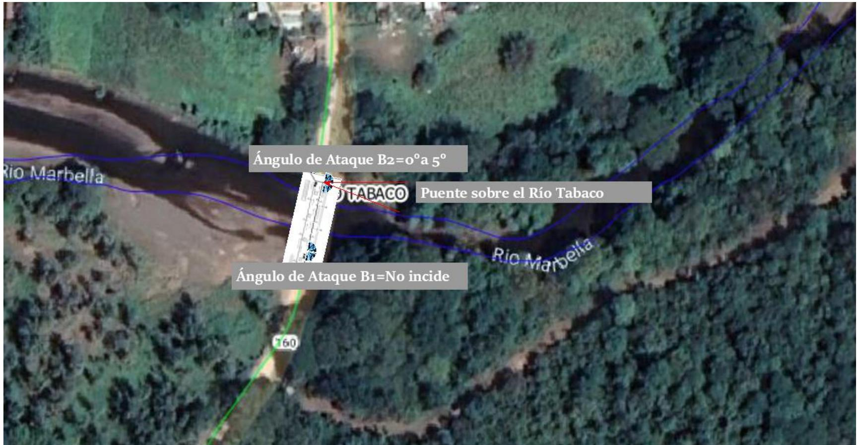
**Ilustración 52:** Ángulos de Ataque de los Bastiones del Puente sobre el Río Tabaco G009
