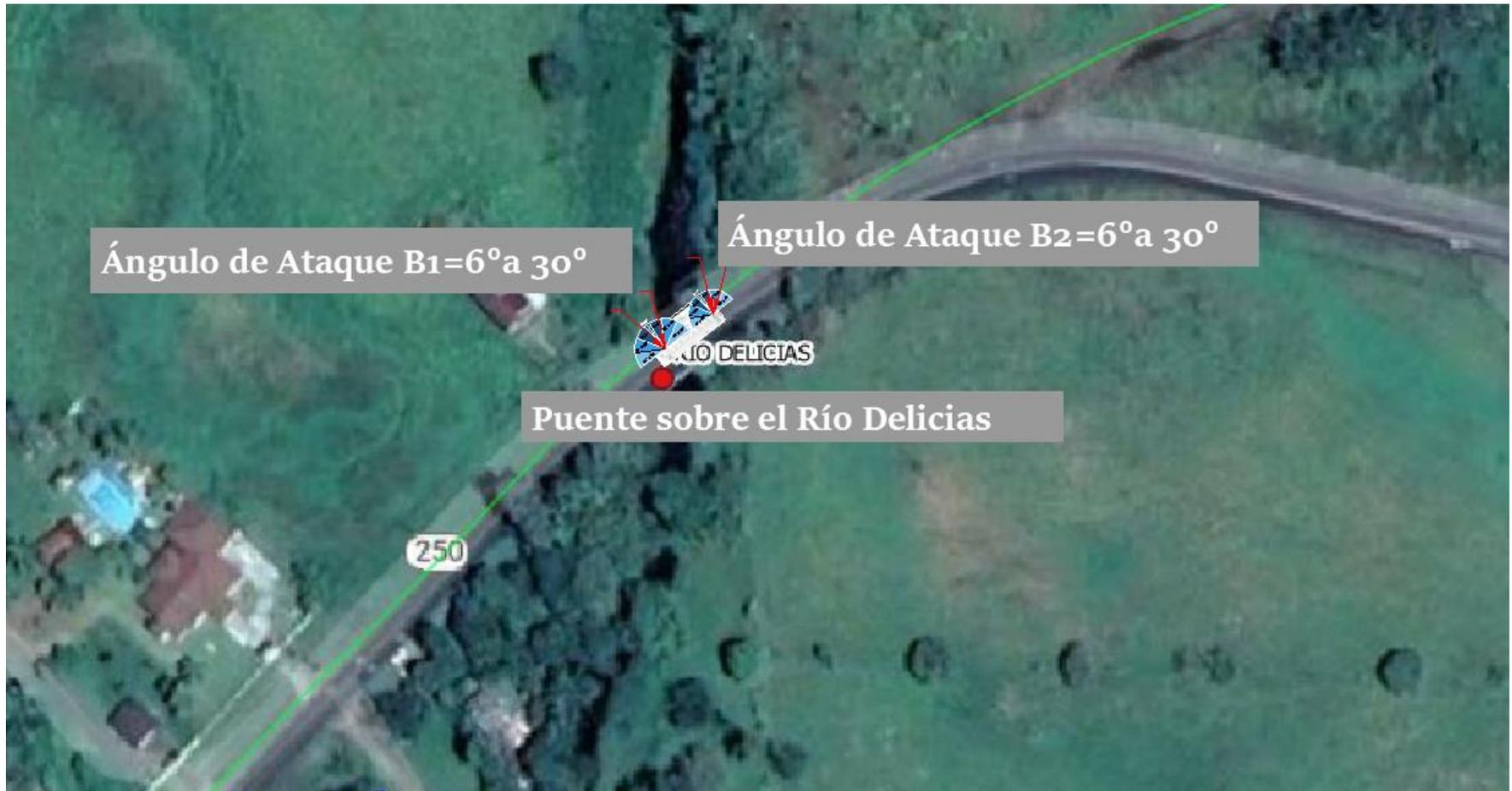
**Ilustración 48:** Ángulos de Ataque de los Bastiones del Puente sobre el Río Delicias A282
