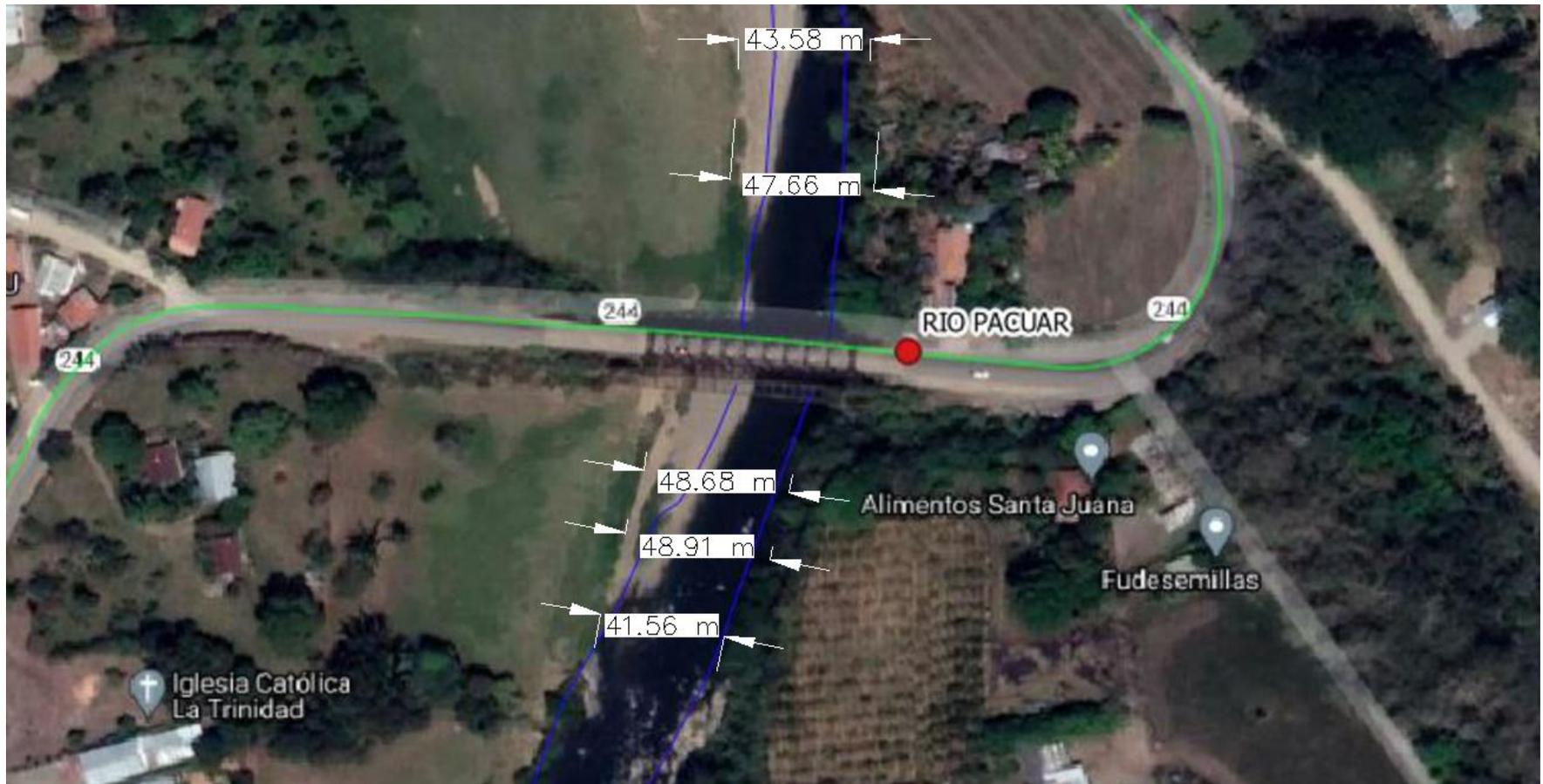
**Ilustración 43:** Revisión de ancho del cauce Puente sobre el Río Pacuar S050.
