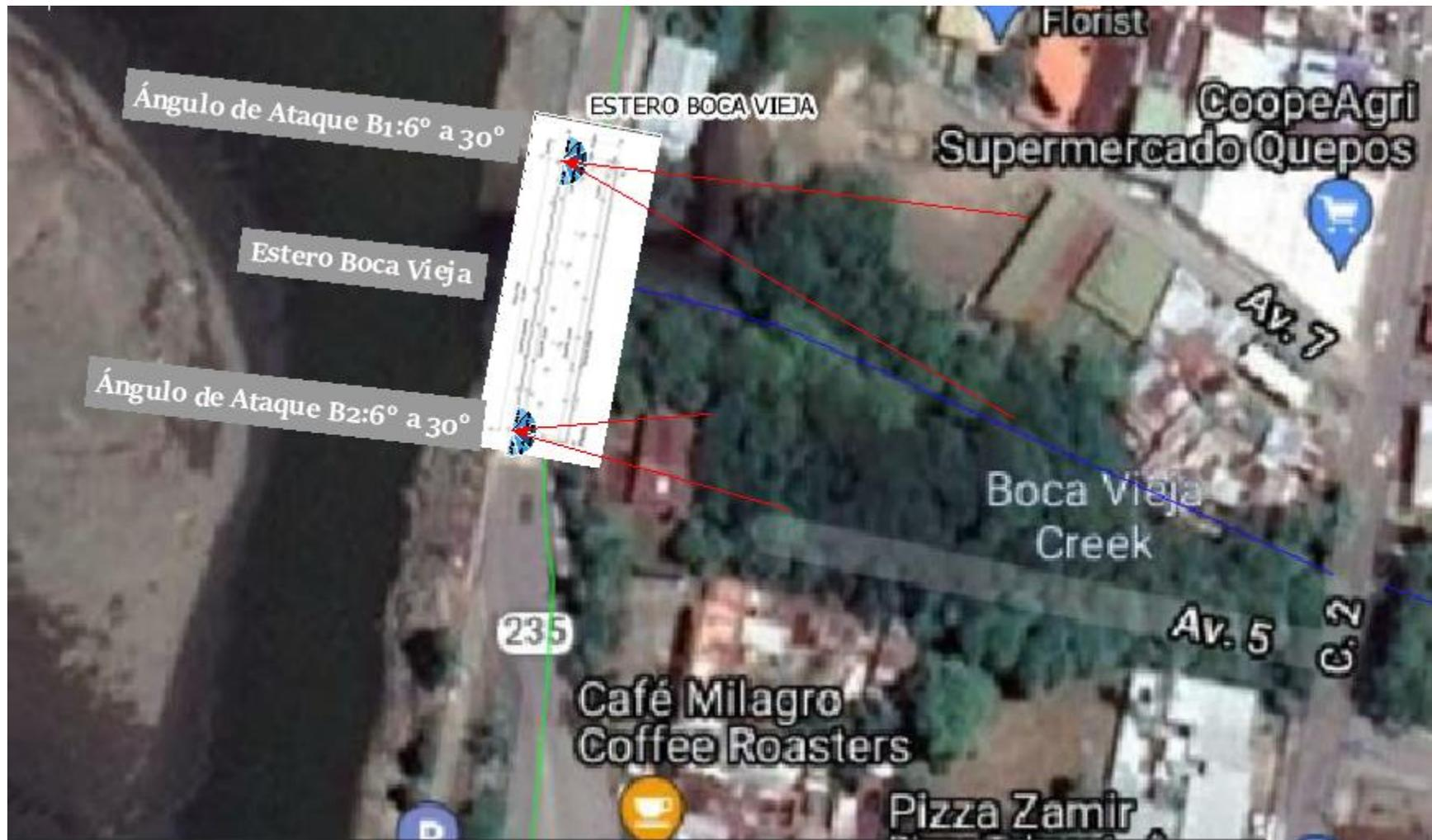
Ilustración 62: Ángulos de Ataque de los Bastiones del Puente sobre el Estero Boca Vieja P065
