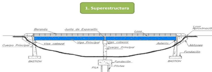
**Ilustración 3:** Componentes de un puente.
