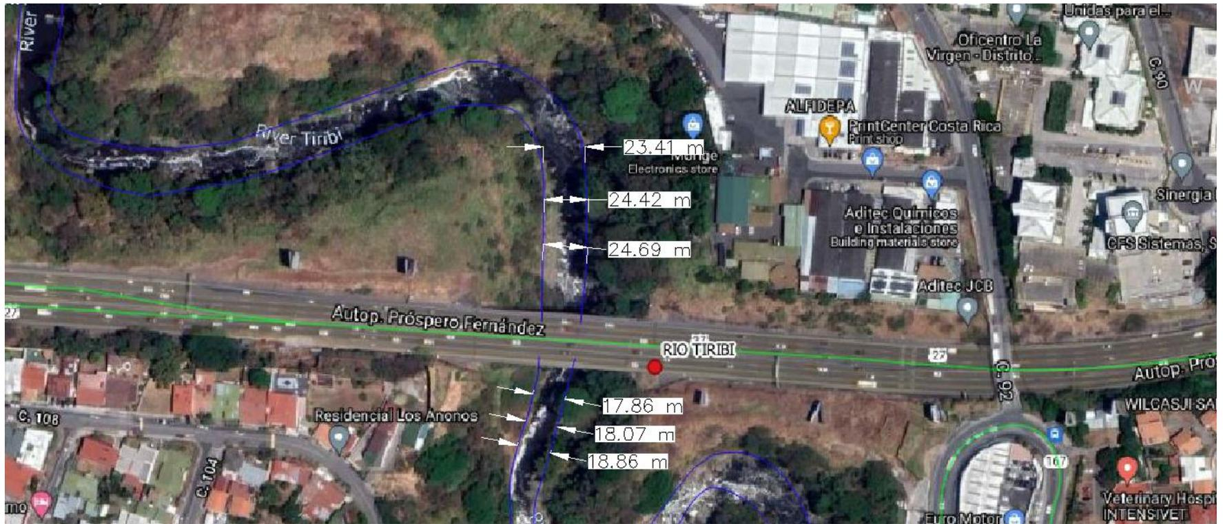
**Ilustración 45:** Revisión de ancho del cauce Puente sobre el Río Tiribí S205.
