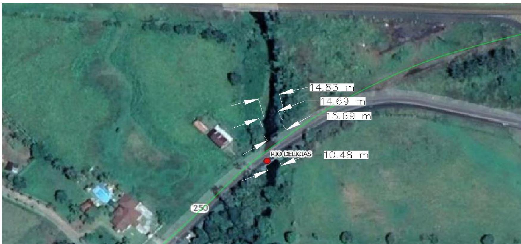
**Ilustración 27:** Revisión de ancho del cauce Puente sobre el Río Delicias A282
