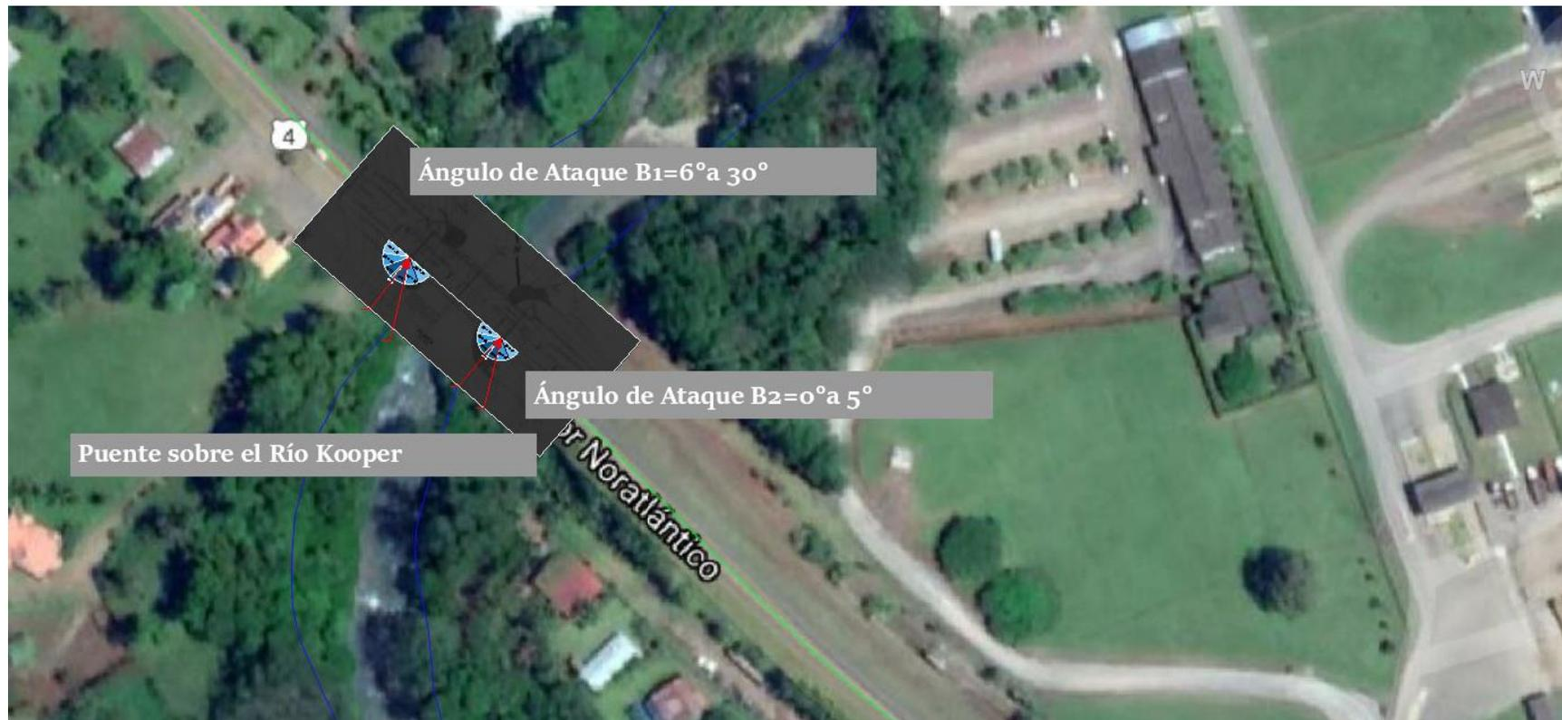
**Ilustración 46:** Ángulos de Ataque de los Bastiones del Puente sobre el Río Kooper A003
