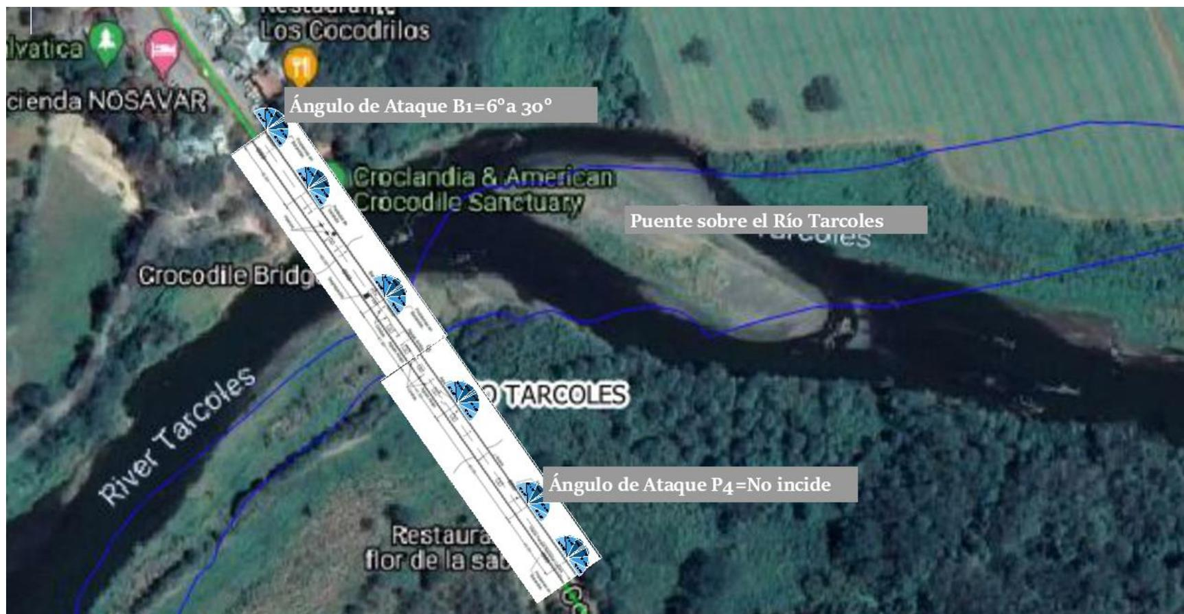
**Ilustración 59:** Ángulos de Ataque de los Bastiones del Puente sobre Río Tárcoles.
