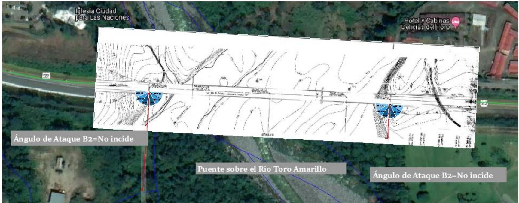
**Ilustración 57:** Ángulos de Ataque de los Bastiones del Puente sobre el Río Toro Amarillo L047
