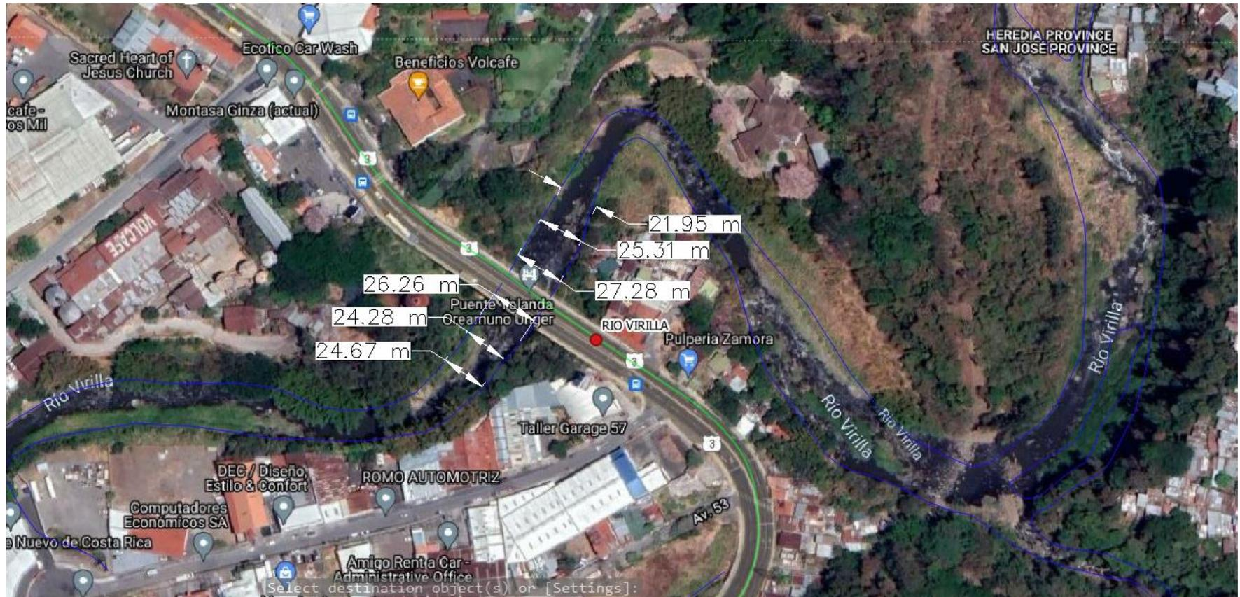
**Ilustración 34:** Revisión de ancho del cauce Puente sobre el Río Virilla H020
