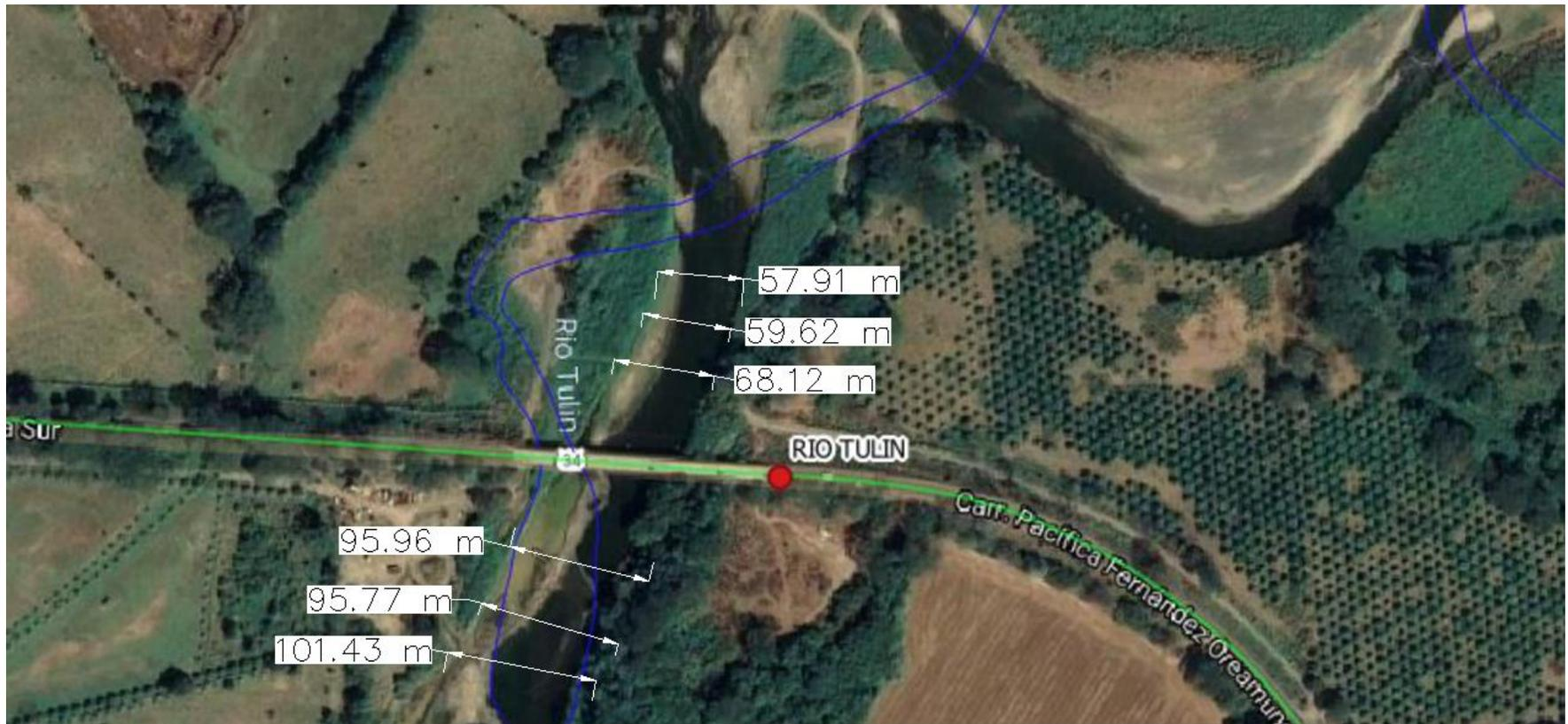
**Ilustración 40:** Revisión de ancho del cauce Puente sobre el Río Tulin P059.
