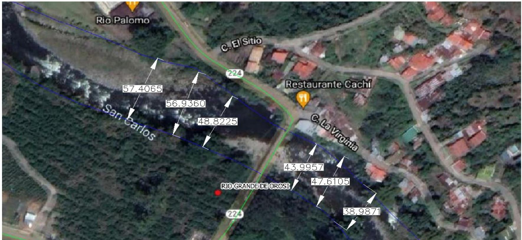
**Ilustración 29:** Revisión de ancho del cauce Puente sobre el Río Grande Orosi C084
