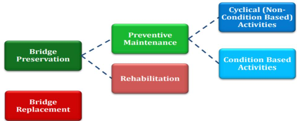
**Ilustración 70:** Tipos de Intervención de los Puentes en estado deficiente.
