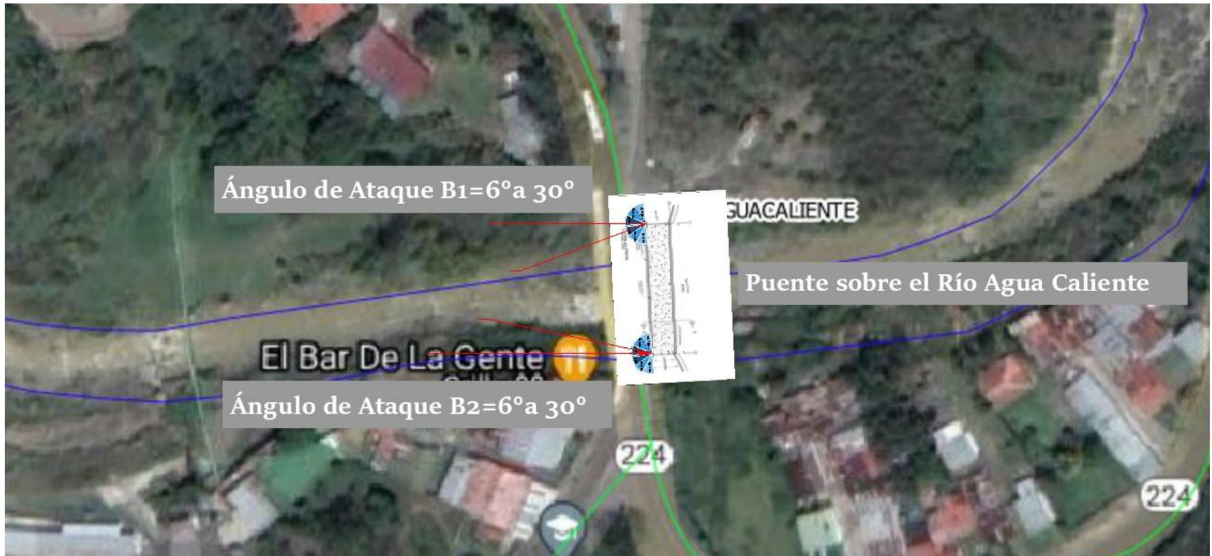
**Ilustración 51:** Ángulos de Ataque de los Bastiones del Puente sobre el Río Agua Caliente C175
