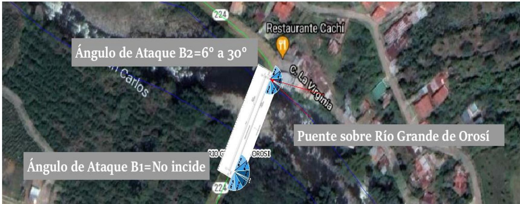
**Ilustración 50:** Ángulos de Ataque de los Bastiones del Puente sobre el Río Grande de Orosí C084
