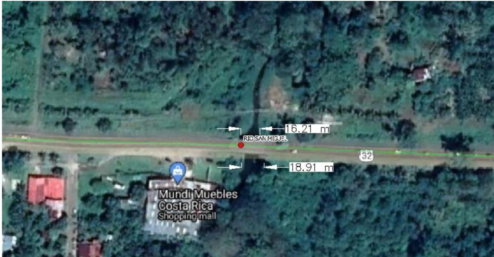
**Ilustración 39:** Revisión de ancho del cauce Puente sobre el Río San Miguel L141.
