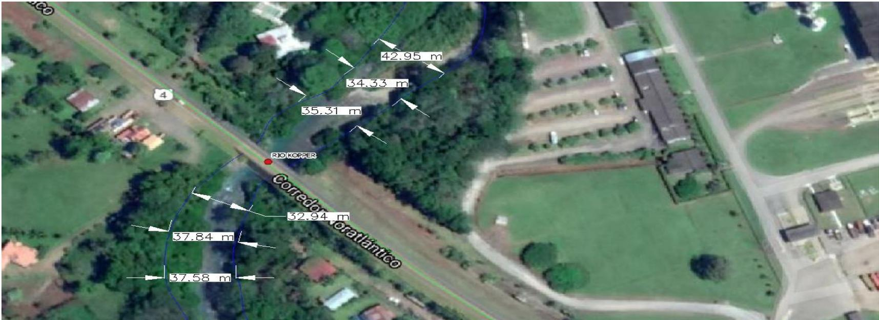
**Ilustración 25:** Revisión de ancho del cauce Puentes sobre el Río Kooper A003
