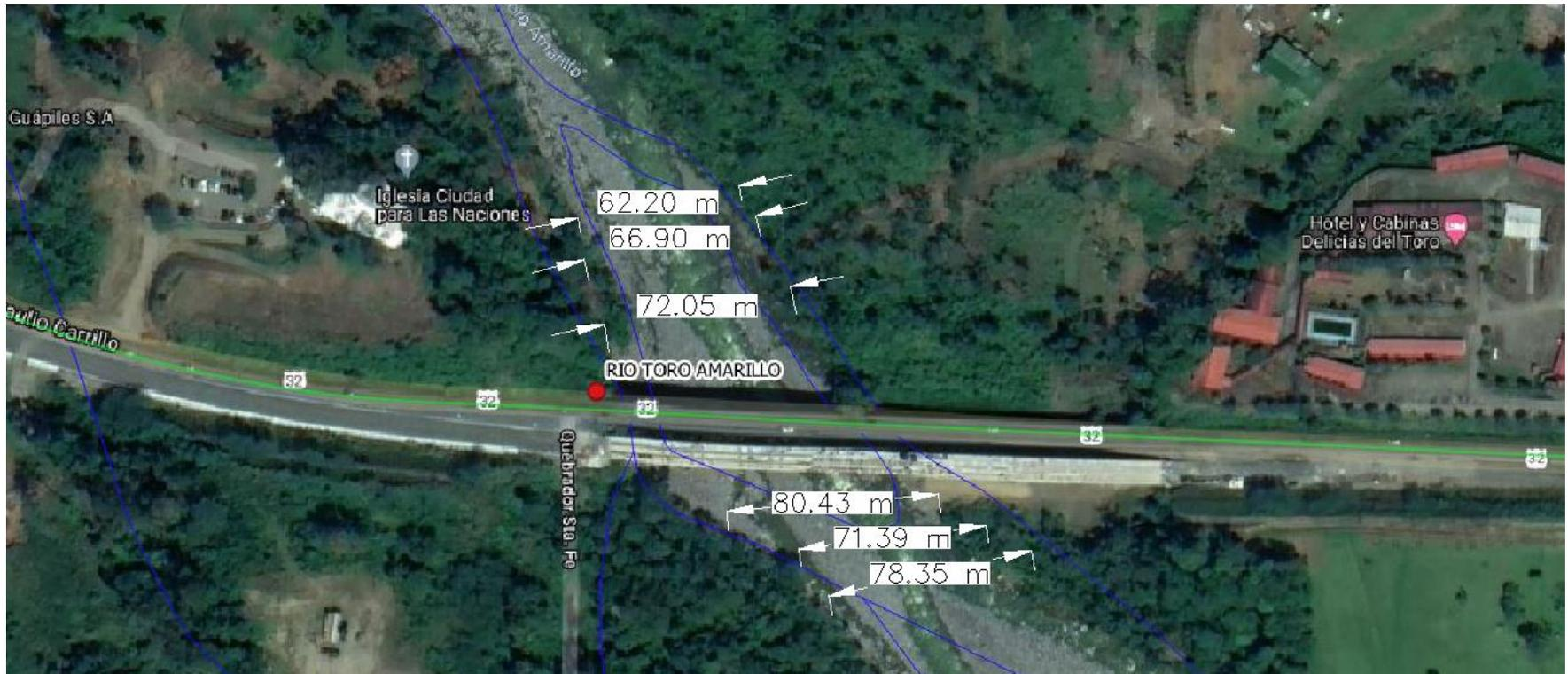
**Ilustración 36:** Revisión de ancho del cauce Puente sobre el Río Toro Amarillo L047
