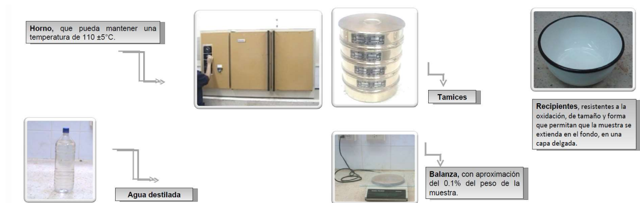
Figura 20: Muestra el equipo para determinar las partículas friables.
