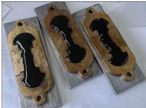
Figura 29: Moldes para el ensayo de recuperación elástica con ductilómetro. Fuente: (Lanamme, 2019).
