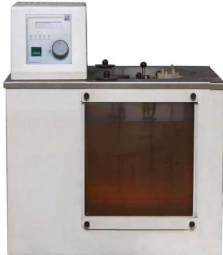
Figura 31: Viscosidad dinamica de asfaltos. Fuente: (Lanamme, 2019).
