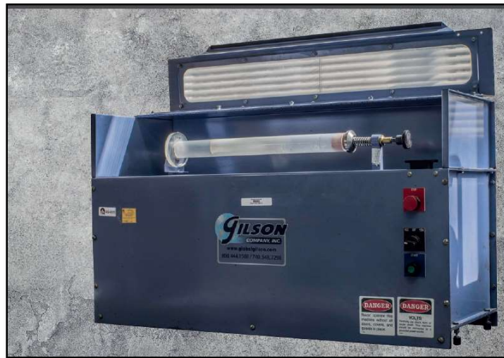
Figura 19: Muestra parte del equipo para determinar la equivalencia de arena en el agregado fino.
