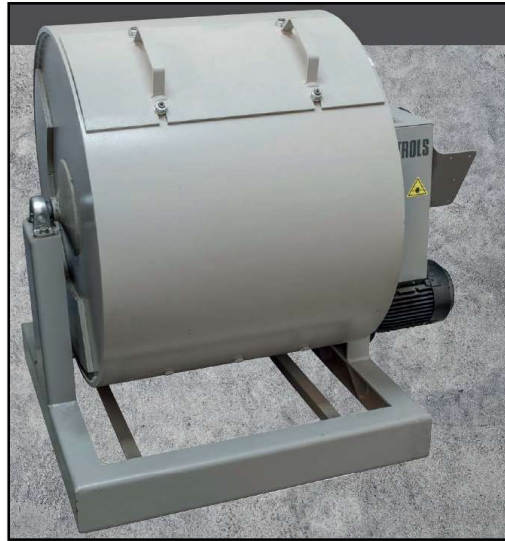
Figura 23: Muestra el equipo para determinar la abrasión del agregado. Fuente: (Lanamme, 2019).
