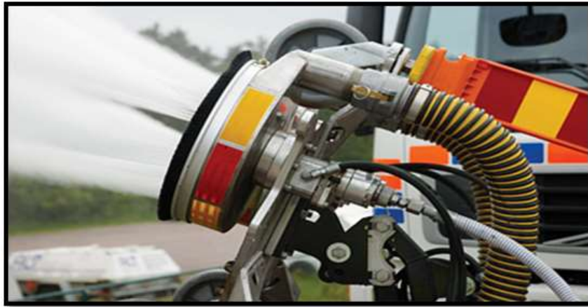
Figura 25: Barras expulsan agua de alta presión. Fuente: Propia.
