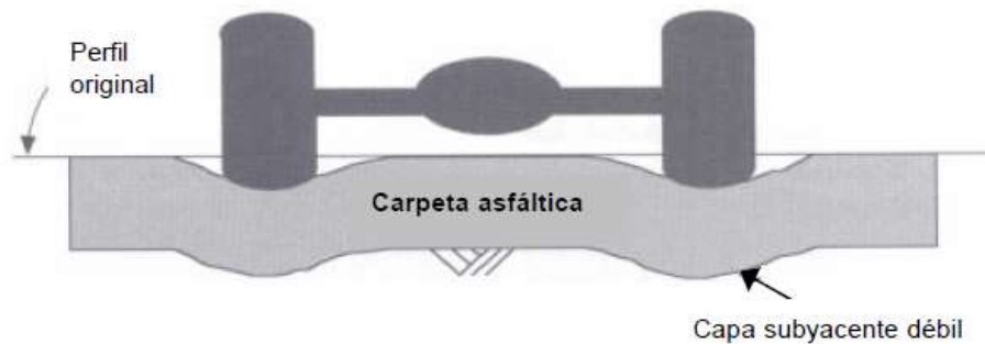
Figura 7: Deformación permanente debido a una capa subyacente débil. Fuente: Instituto Mexicano de Transporte
