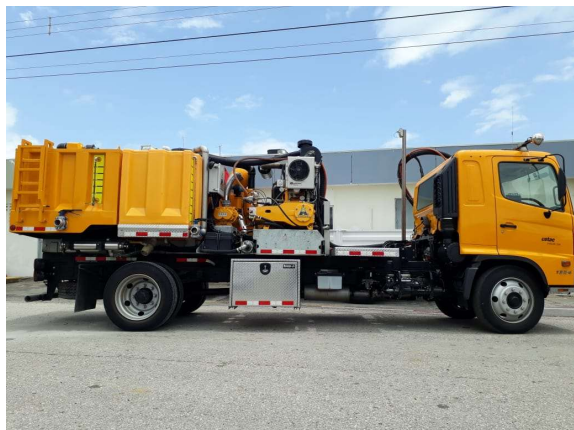
Figura 14: Equipo para recolección del caucho. Fuente: Propia.
