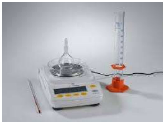
Figura 30: Método del picnómetro para calcular densidades. Fuente: Propia
