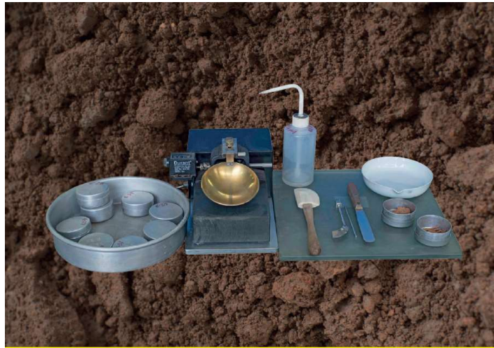
Figura 21: Muestra el equipo para determinar los Límites de Attemberg. Fuente: (Lanamme, 2019).
