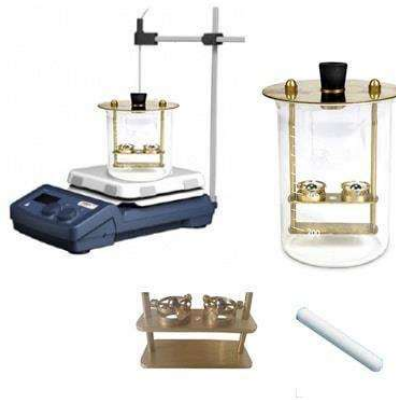
Figura 28: Muestra el equipo para determinar el punto de ablandamiento Fuente: (Lanamme, 2019).
