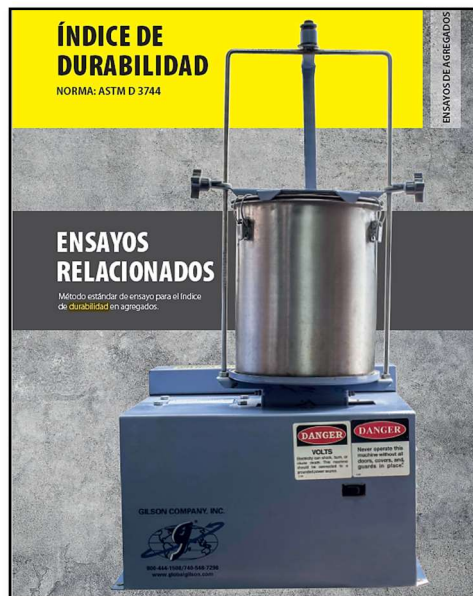
Figura 26: Muestra parte del equipo para determinar la resistencia relativa de los agregados. Fuente: (Lanamme, 2019).
