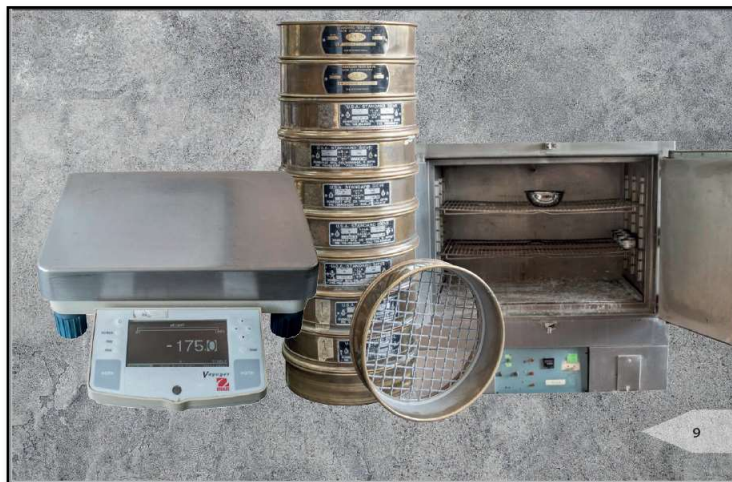
Figura 18: Muestra el equipo para determinar la gravedad específica y absorción del agregado. Fuente: (Lanamme, 2019).
