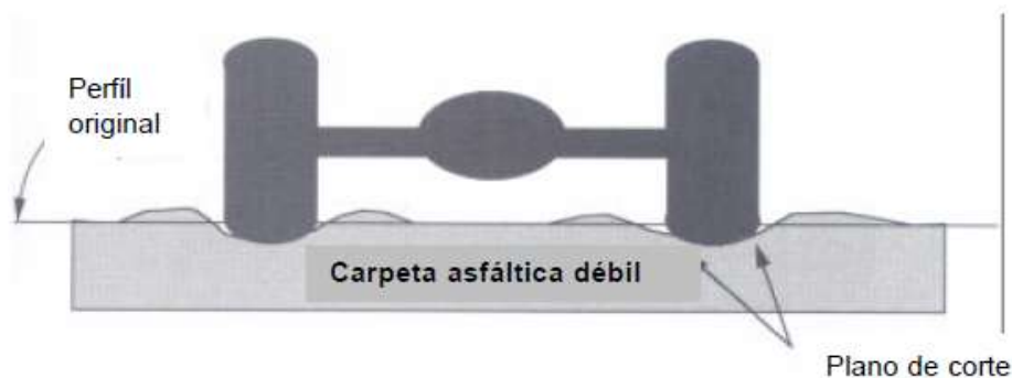
Figura 8: Deformación permanente debido a una mezcla asfáltica débil. Fuente: Instituto Mexicano de Transporte.
