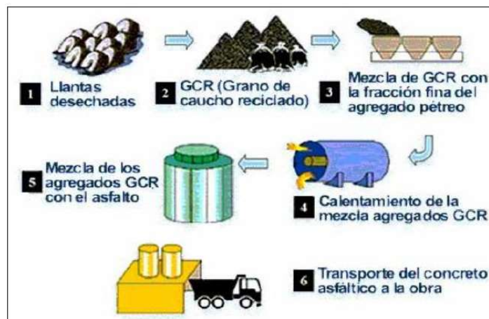
Figura 5: Descripción del proceso por vía seca. Fuente: (Díaz Claros & Castro Celis, 2017).
