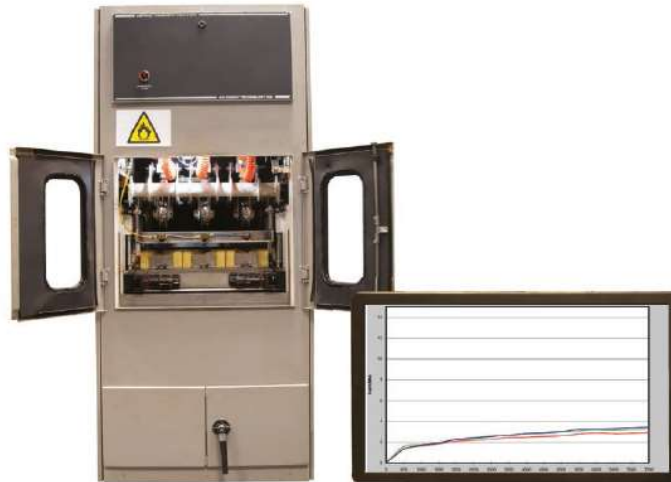
Figura 9: Analizador de pavimentos asfálticos (APA). Fuente: (Lanamme, 2019)
