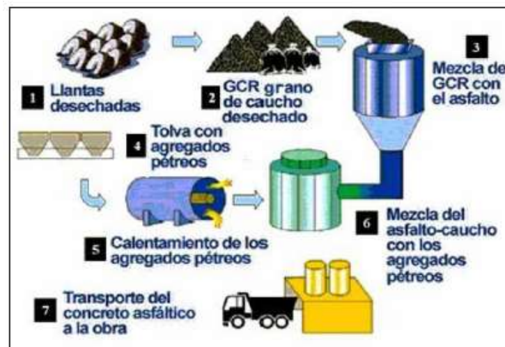
Figura 6: Descripción del proceso por vía húmeda. Fuente: (Díaz Claros & Castro Celis, 2017)
