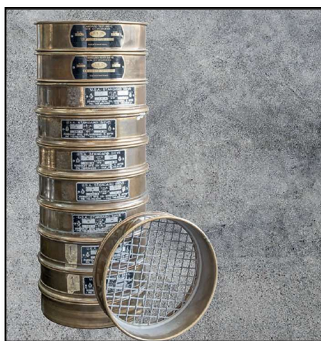
Figura 16: Muestra el equipo para el tamizaje del agregado grueso y fino. Fuente: (Lanamme, 2019).
