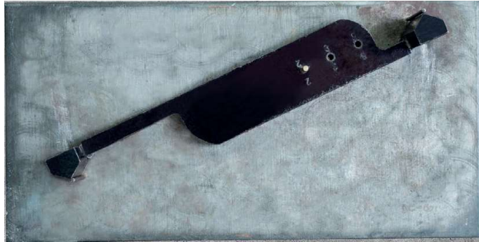
Figura 25: Muestra parte del equipo para determinar longitud/ancho del agregado. Fuente: (Lanamme, 2019).
