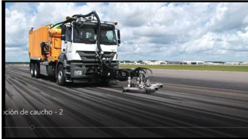
Figura 24: Equipo de limpieza de caucho en la pista del AIDOQ.. Fuente: Propia.
