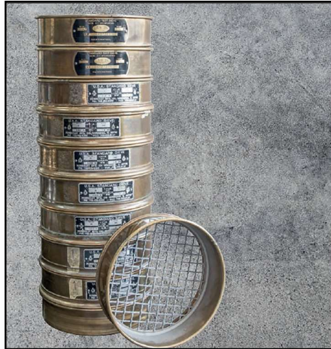
Figura 27: Muestra el equipo para el tamizaje del agregado grueso y fino. Fuente: (Lanamme, 2019).
