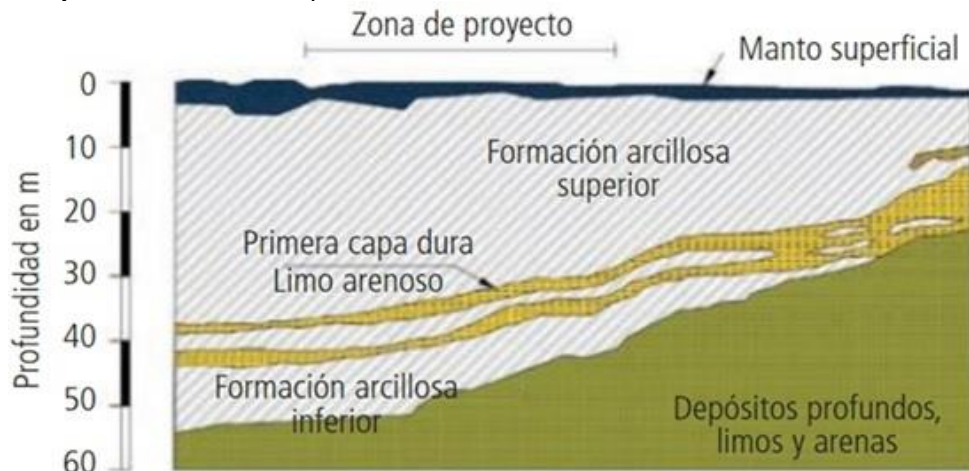
Figura 3. Perfil estratigráfico Fuente: Zárate (2016).
