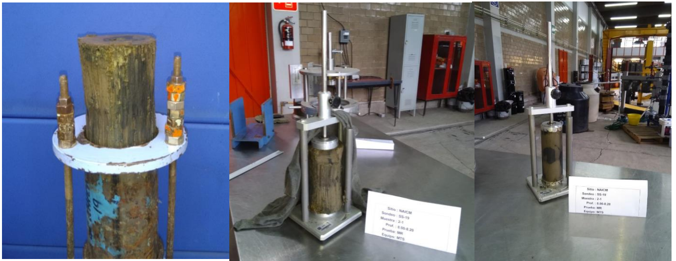
Figura 83. Extracción y labrado de las probetas de suelo. Fuente: elaboración propia.
