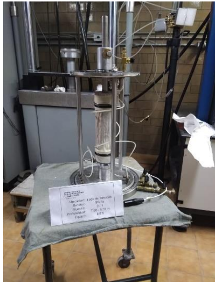
Figura 85. Montaje de la probeta de suelo en la cámara triaxial. Fuente: elaboración propia.
