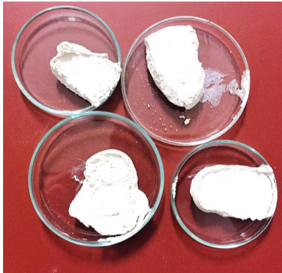
Figura 10. Muestras llevadas al horno para la determinación de la cantidad de humedad del suelo para determinar el límite líquido.
