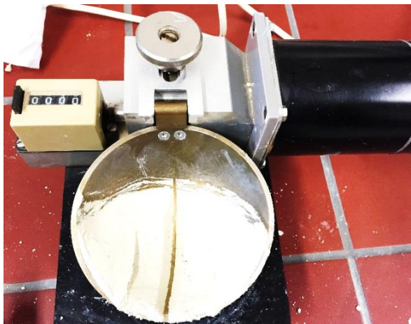
Figura 11. Muestra de la caolinita en la Copa de Casagrande con la ranura, lista para comenzar los golpes.
