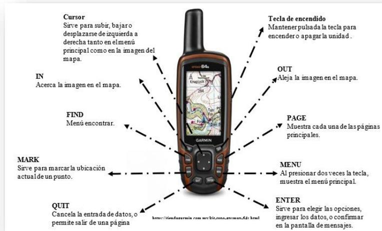
**Figura 6.** Partes y funcionamiento de un GPS marca GARMIN
