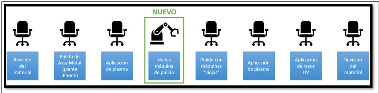
**Figura 9.3.** Secuencia propuesta para incluir la máquina de pulido semiautomática en el proceso de Buff and Polish.
