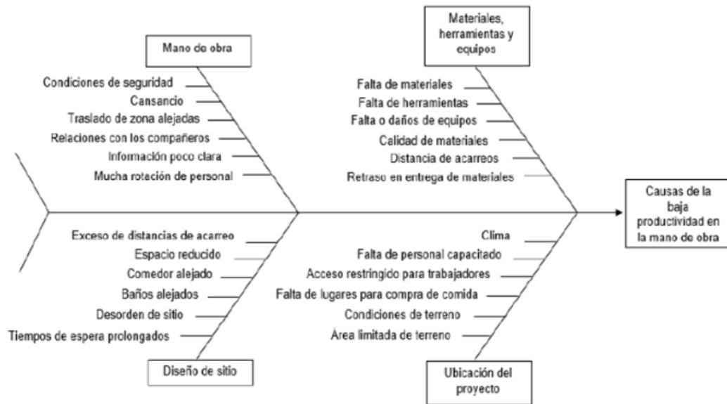
Figura 50. Diagrama Ishikawa Edificio TIC'S Fuente: Camacho D. (2016)
